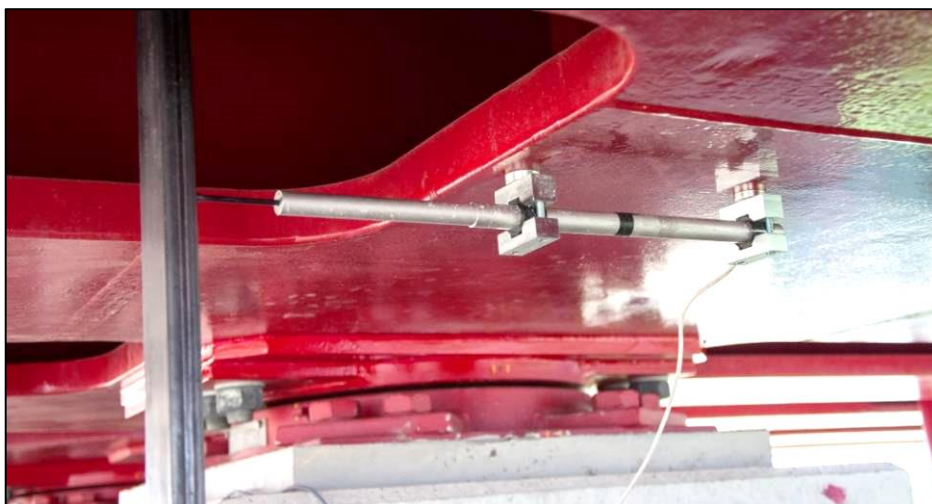
Obrázek 16: Induktivní snímač dráhy DH 100
