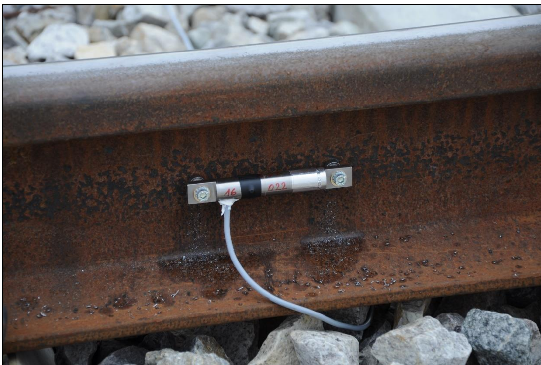
Obrázek 14: Induktivní snímač přetvoření SP_1_100
