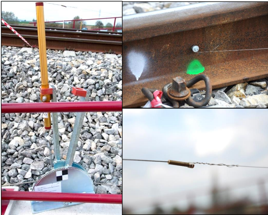
Obrázek 17: Strunový induktivní snímač dráhy DKBT 50
