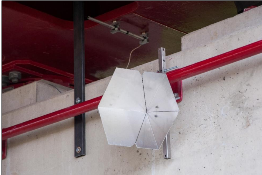
Obrázek 20: Koutový odražeč na pilíři
