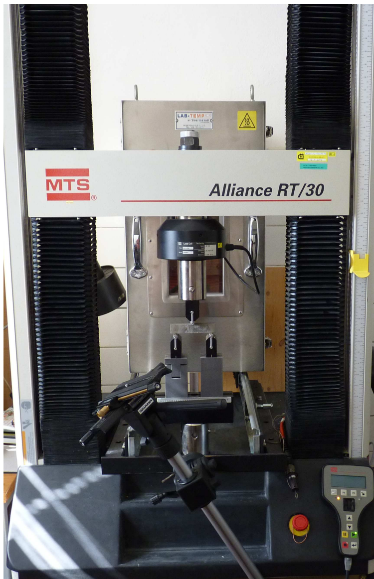
Obr. č. 1 – Fotografie zkušebního přístroje MTS ALLIANCE RT 30 kN.
