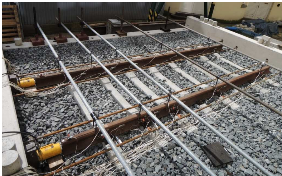
Obr. 44: Zkoušená konstrukce, nad kolejnicemi lešenářské trubky pro nezávislé umístění snímačů
