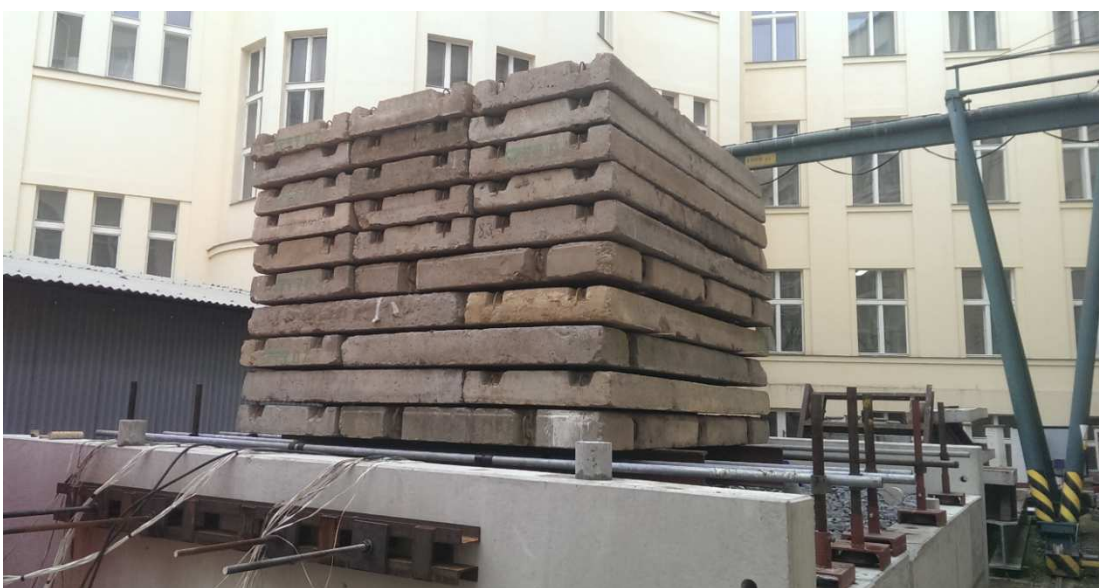
Obr. 105: Kompletní zatížení koleje
