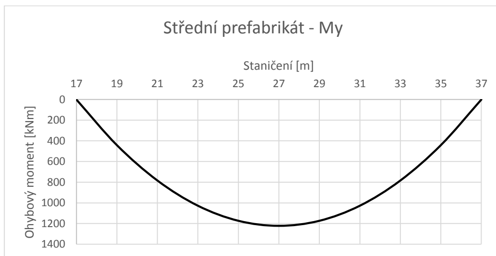
Obr. 21 - Průběh ohybových momentů na středním prefabrikátu
