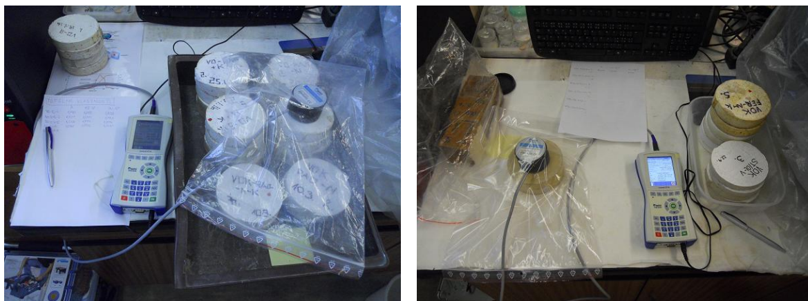
Obr. 94: Měření tepelně-technických vlastností přístrojem Isomet
