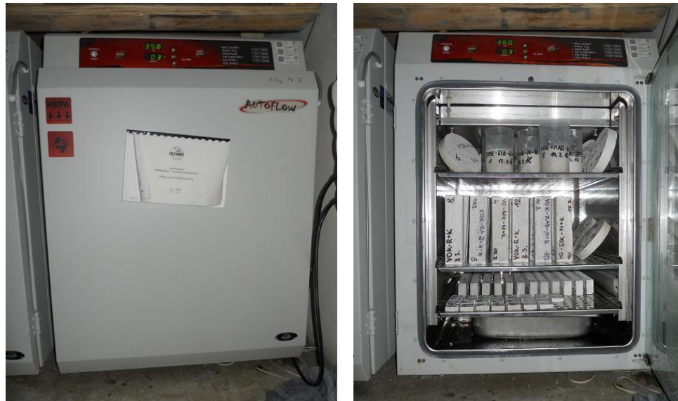
Obr. 56: Vlevo: karbonatační komora, vpravo: vzorky uložené v karbonatační komoře
