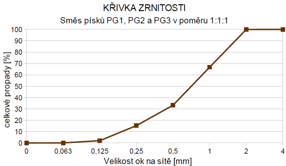
Obr. 43: Křivka zrnitosti směsi písků PG 1, PG 2 a PG 3 v poměru 1 : 1 : 1
