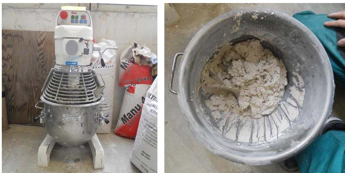
Obr. 51: Vlevo: normová míchačka, vpravo: směs po ručním zamíchání
