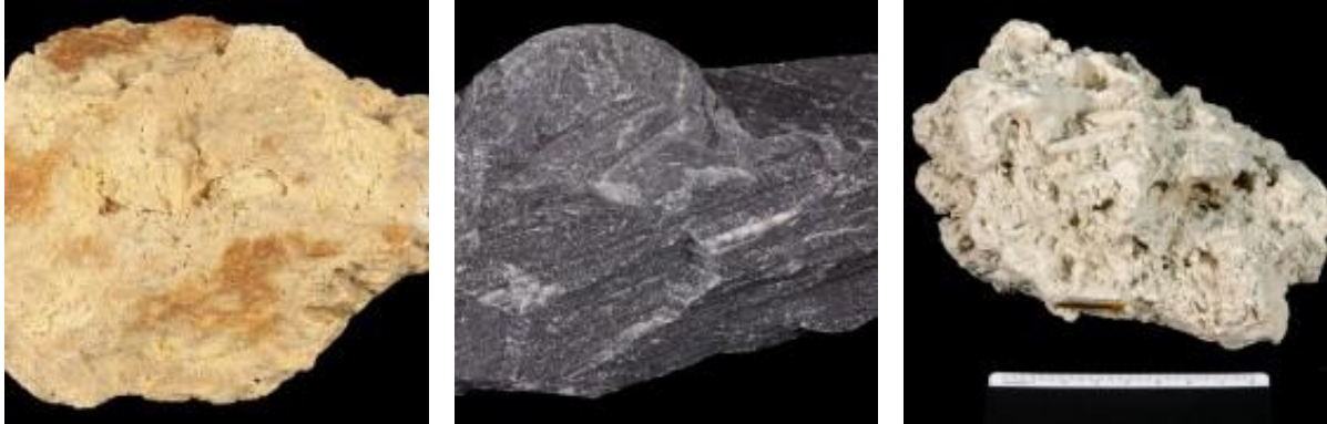
Obr. 1: Různé druhy vápence. Vlevo: žlutá hornina z Polska, uprostřed: tmavá, téměř černá hornina z Brazílie (nejčistší), vpravo: vápenec s vysokým obsahem korálů a mušlí z Dánska [10]
