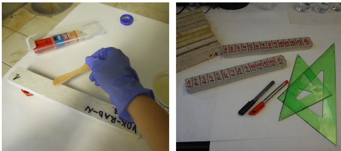
Obr. 78: Vlevo: zaizolování vzorku epoxidovým lepidlem, vpravo: vzorky s narýsovanou stupnicí
