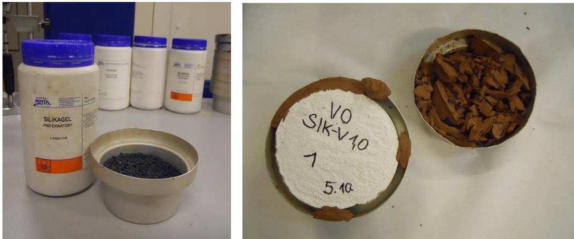
Obr. 87: Vlevo: miska naplněná silikagelem, vpravo: utěsňování vzorku v misce
