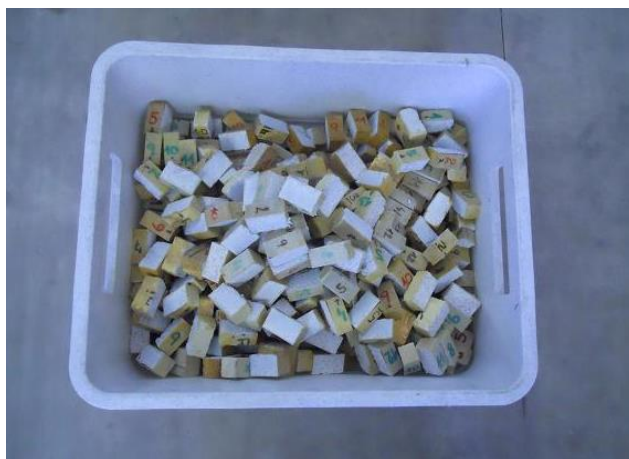
Obr. 81: Nařezané dílky zbylé po měření svislé nasákavosti u vzorků skupiny VO
