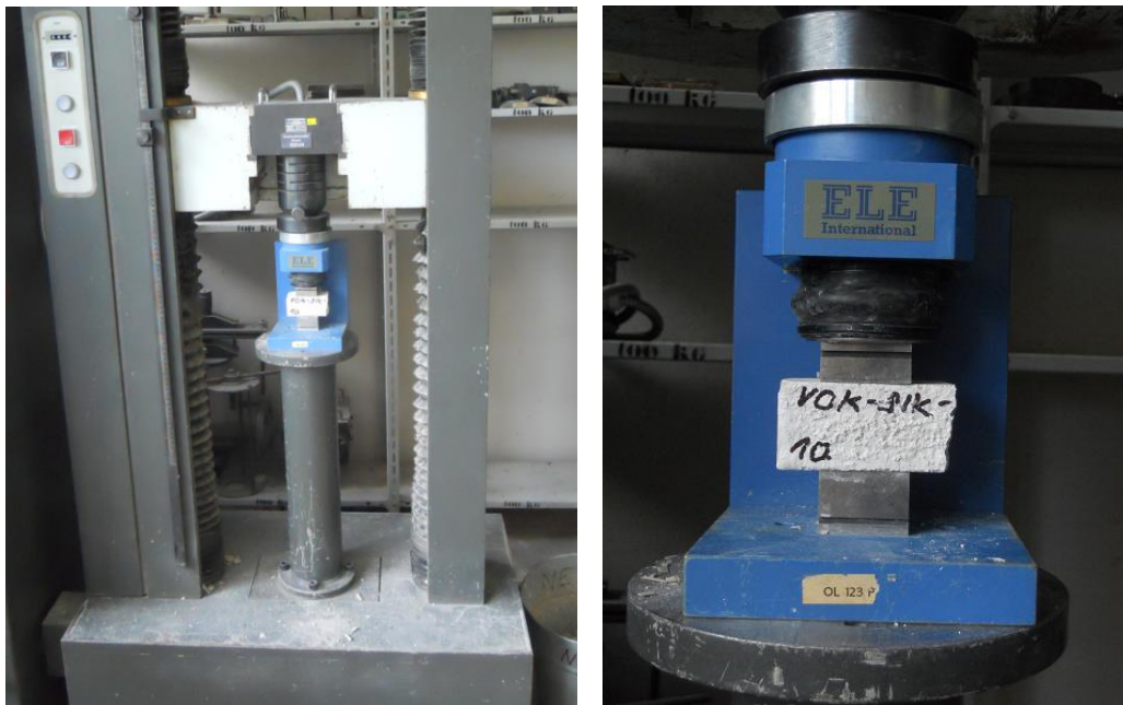
Obr. 69: Vlevo: umístění nástavce do zkušebního zařízení, vpravo: těleso v nástavci firmy ELE International pro zkoušku v tlaku
