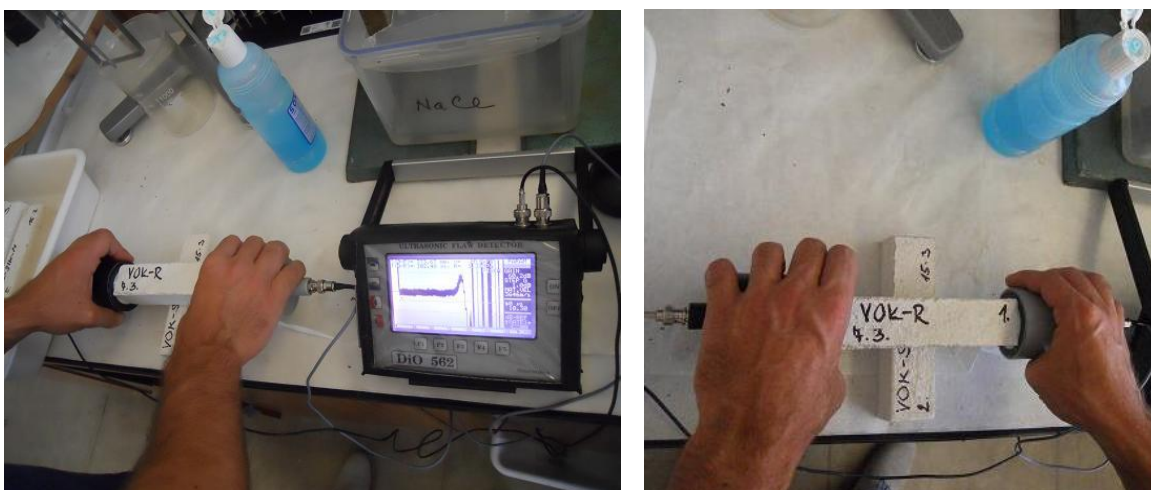
Obr. 71: Vlevo: aparatura pro měření dynamického modulu pružnosti, vpravo: průchod vlnění z budiče skrz vzorek do snímače
