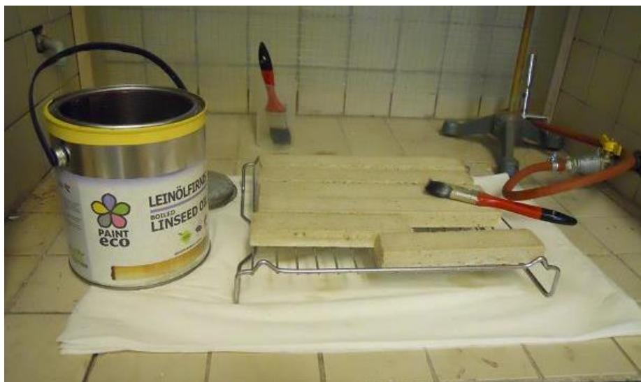
Obr. 55: Aplikace nátěru lněné fermeže
