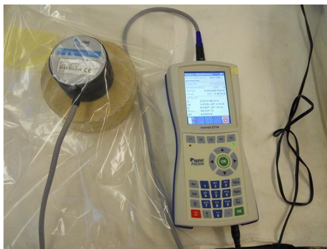
Obr. 95: Vzorek uzavřený v PE obalu po dobu měření
