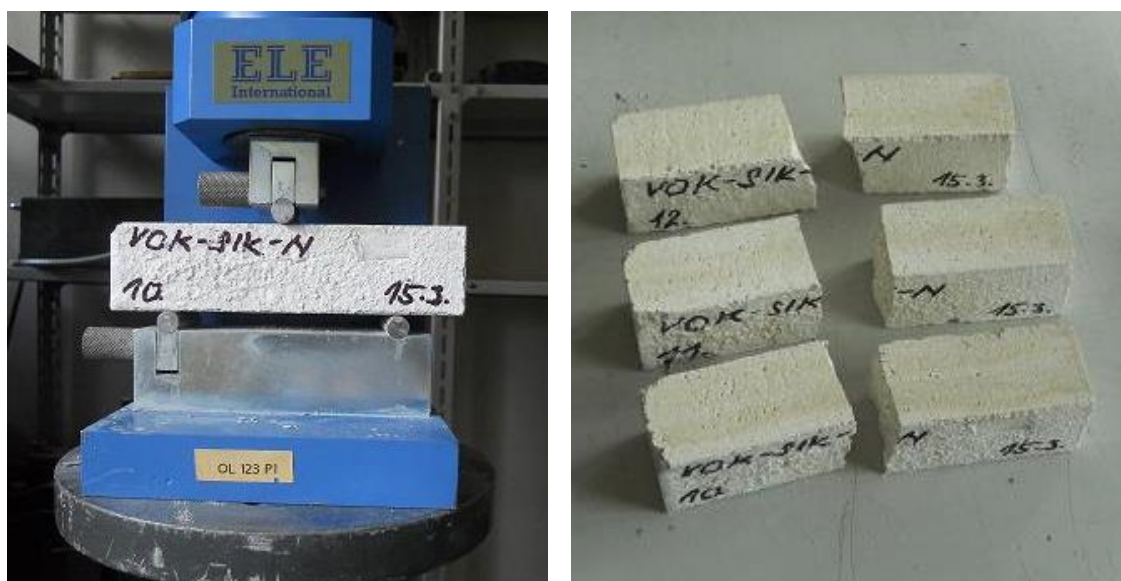
Obr. 68: Vlevo: umístění tělesa v nástavci firmy ELE International pro zkoušku v tahu za ohybu, vpravo: rozlomené trámečky po zkoušce pevnosti v tahu za ohybu
