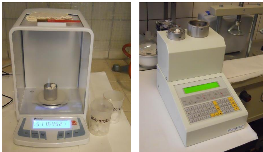
Obr. 60: Vlevo: vážení vzorku na digitálních vahách, vpravo: vzorek připravený v měřící nádobce pyknometru
