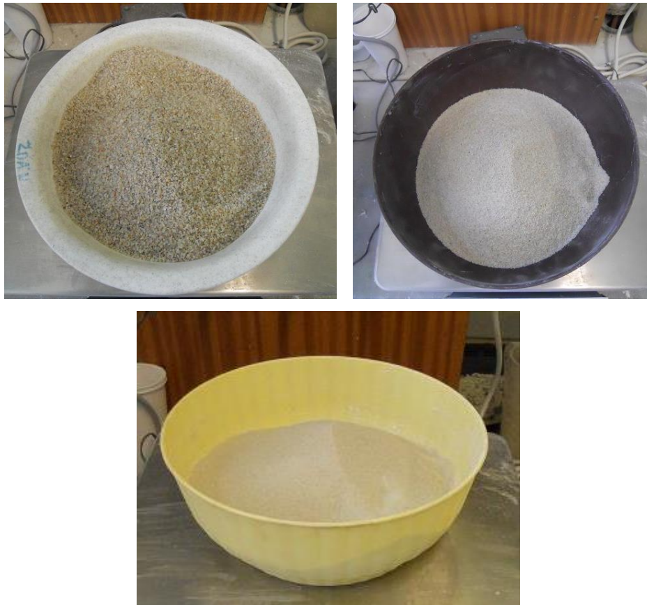
Obr. 44: Vlevo nahoře: písek PG 3, vpravo nahoře: písek PG 2, dole: písek PG 1
