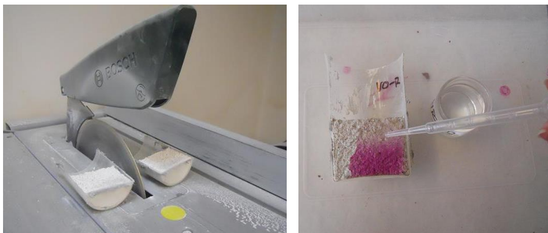
Obr. 57: Vlevo: řezání váženky, vpravo: aplikace roztoku fenolftaleinu
