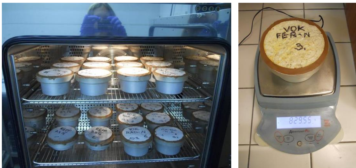
Obr. 88: Vlevo: vzorky v klimatizační komoře, vpravo: vážení vzorku
