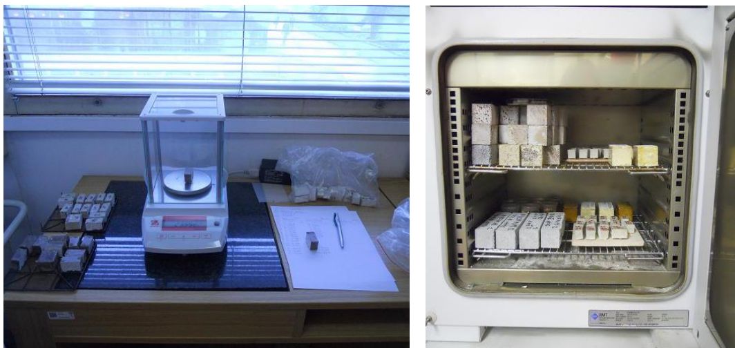
Obr. 80: Vlevo: vážení dílků, vpravo: vzorky v sušárně
