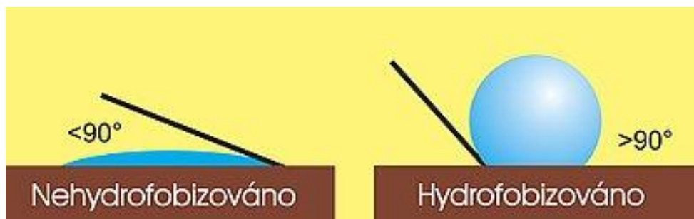
Obr. 27: Smáčecí úhel kapaliny na nehydrofobizovaném materiálu a na hydrofobizovaném materiálu [9]
