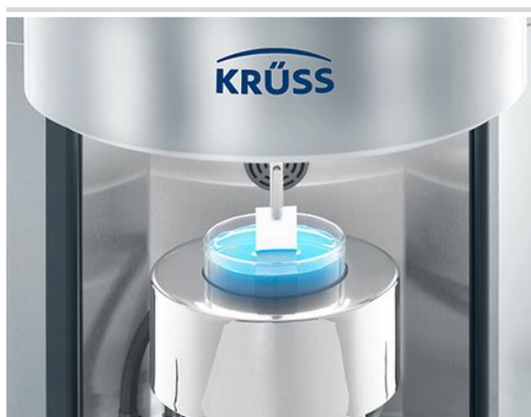
Obr. 25: Metoda vyvažování Wilhelmyho destičky – detail přístroje firmy Krüss [32]
