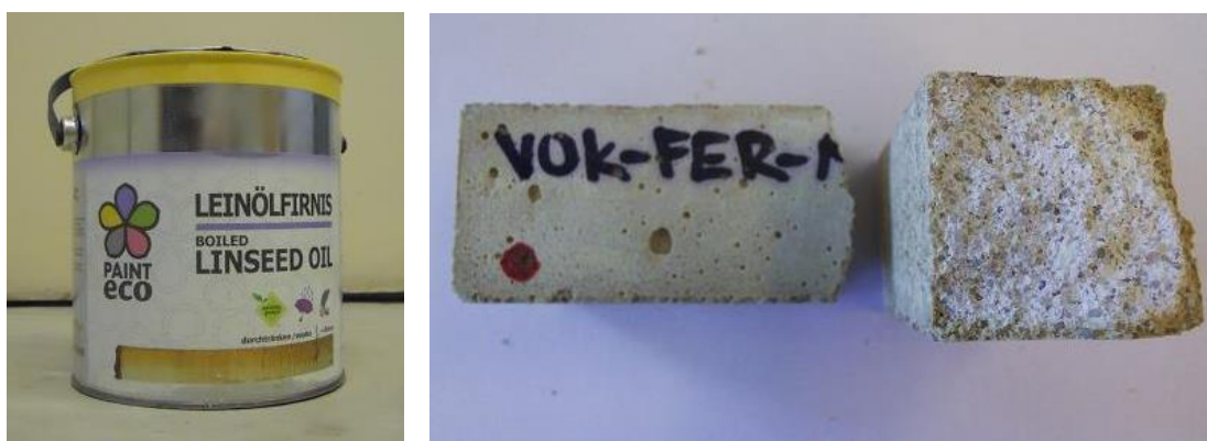
Obr. 47: Vlevo: Lněná fermež od výrobce Painteco, vpravo: vzorky ošetřené lněnou fermeží
