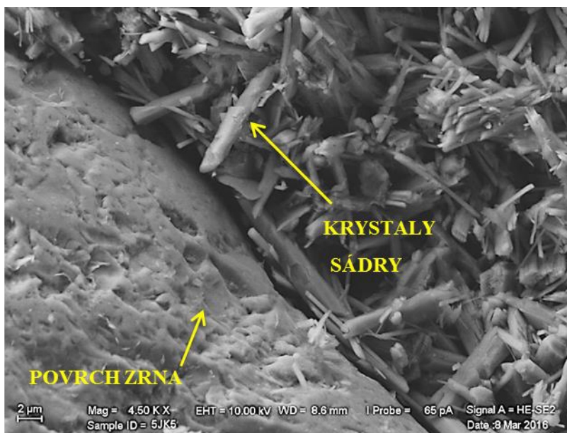
Obr. 21: Tranzitní zóna směsi S5 (s říčním pískem)
