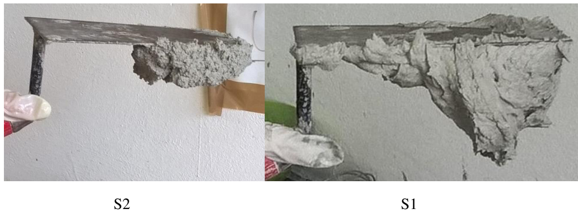
Obr. 23: Chování čerstvé malty S2 s normalizovaným pískem a sádry bez plniva S1
