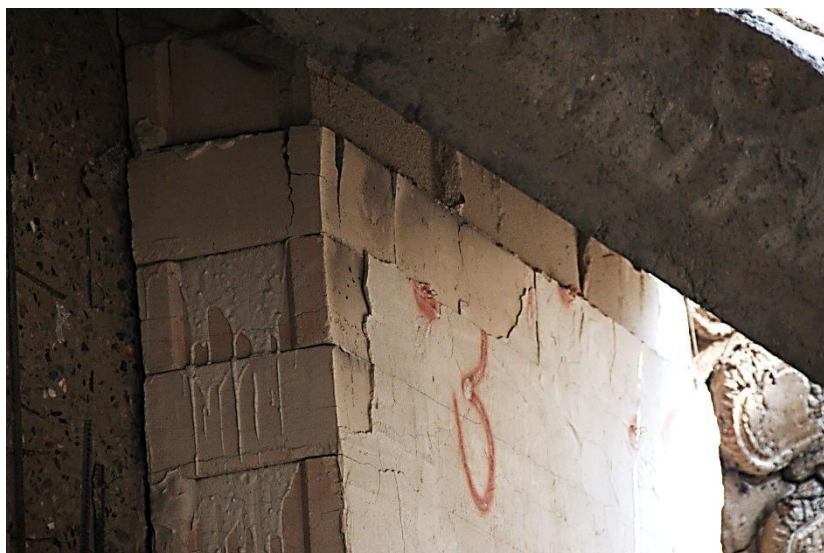
Obr. 4: Detail stěny ze sádrových bloků po požární zkoušce [26]
