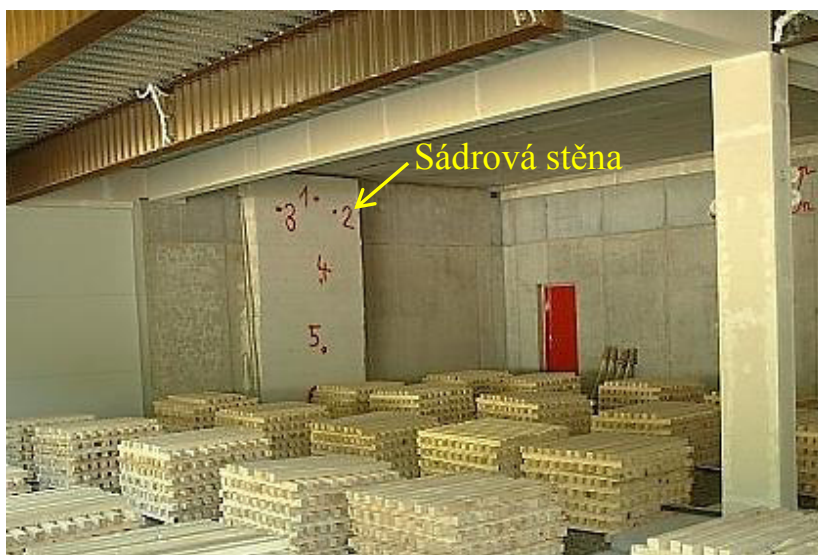
Obr. 3: Stěna ze sádrových bloků před požární zkouškou [25]
