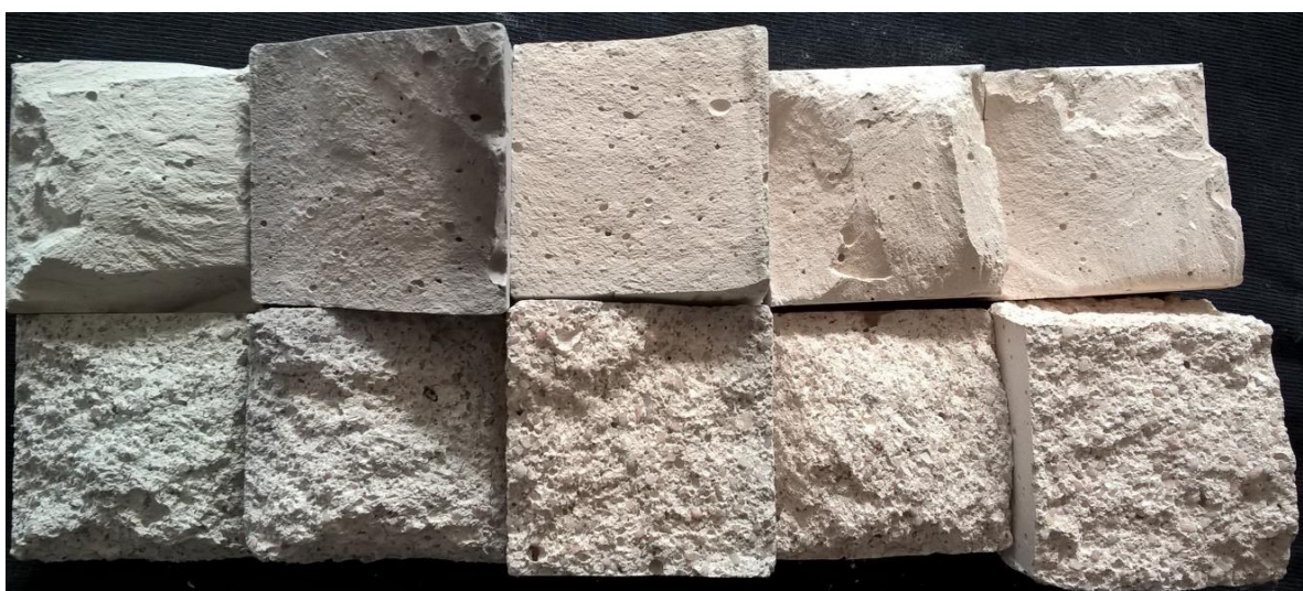
Obr. 47: Příčný řez směsí S1 (bez plniva, nahoře) a směsí S2 (s normalizovaným pískem, dole) po zatížení teplotami 50 °C (vlevo), 400 °C, 500 °C, 650 °C a 800 °C (vpravo)
