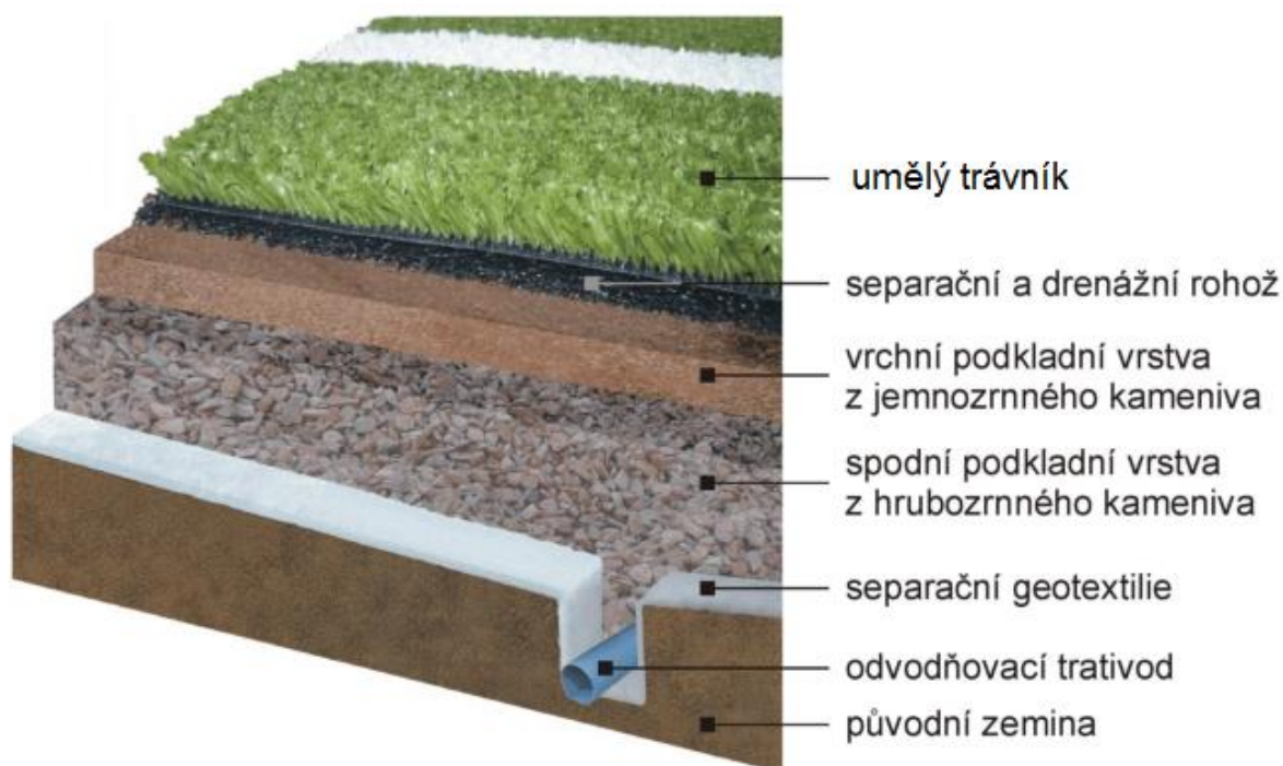
Obrázek 15 Řez podkladem umělého trávníku [24]
