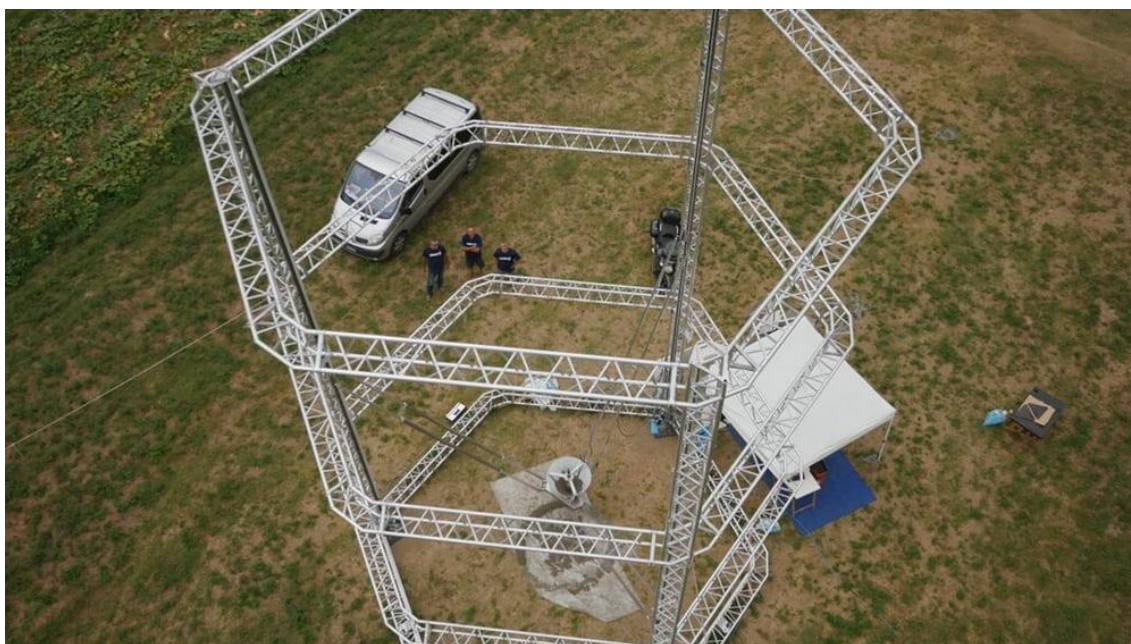
Obrázek 23: Konstrukce 3D tiskárny Big Delta
