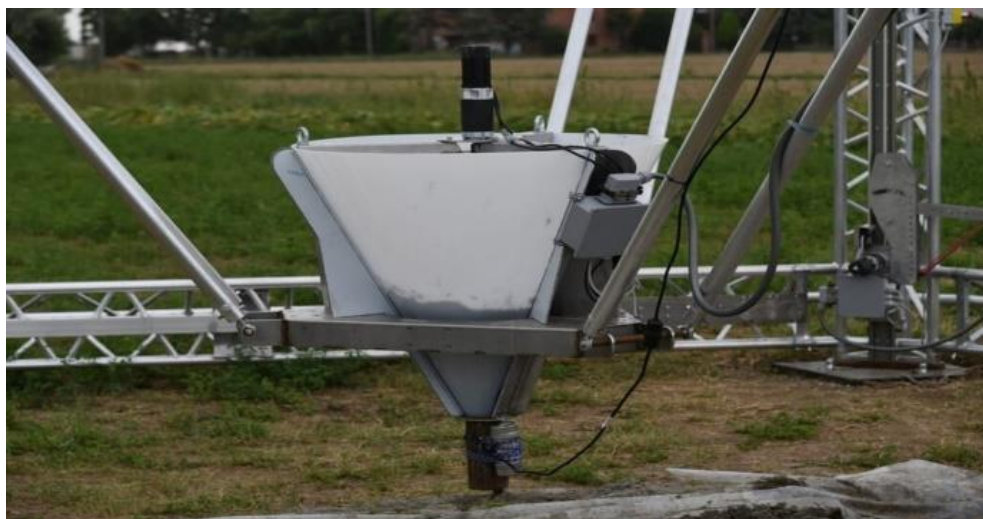
Obrázek 22: Hlavice 3D tiskárny Big Delta
