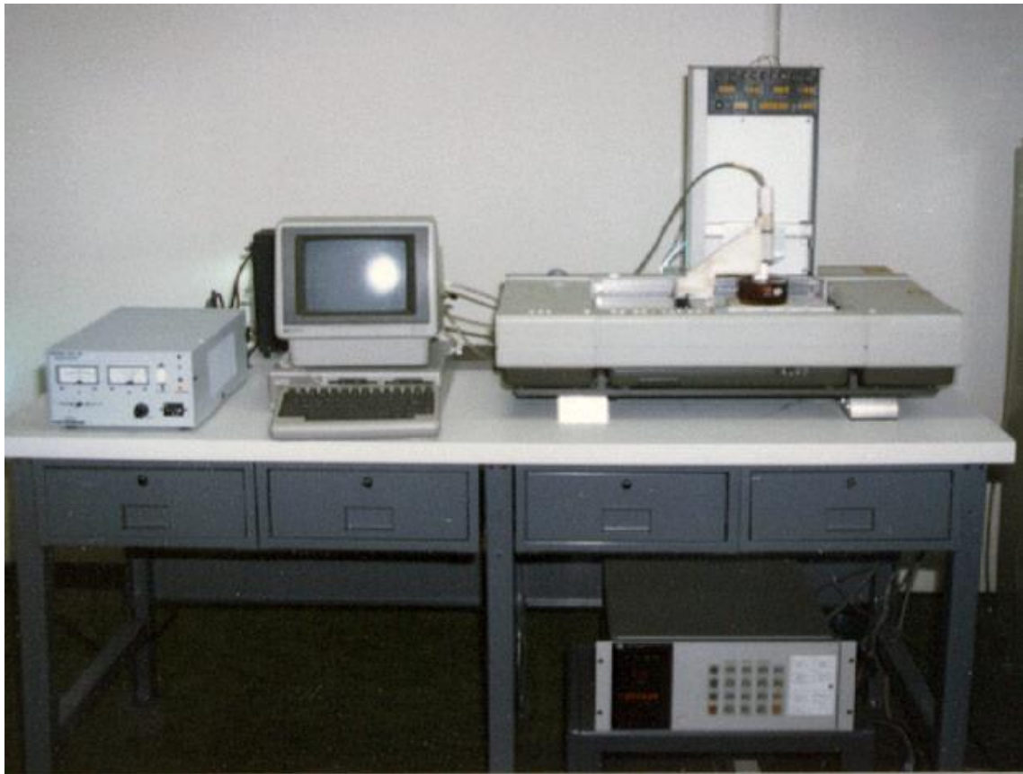
Obrázek 6: První 3D tiskárna Stereolithography Apparatus SLA-1 zdroj: [20]
