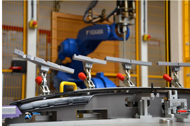
Obrázek 33: Kopyta tvarování autodílů použita ve výrobní lince
