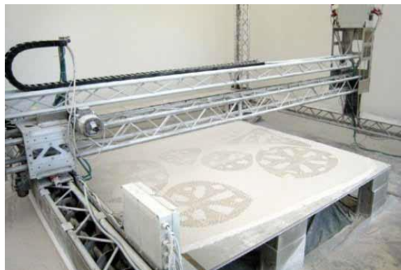
Obrázek 17: Plošný 3D tisk – D-SHAPE – Monolite UK - Enrico Dini Zdroj: [27]
