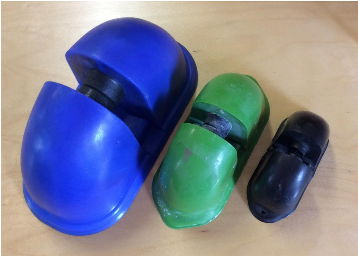
Obrázek 19: Forma pro tvorbu kotevního bodu z ŽB stropní konstrukci. [archiv spol. Skanska a.s.]
