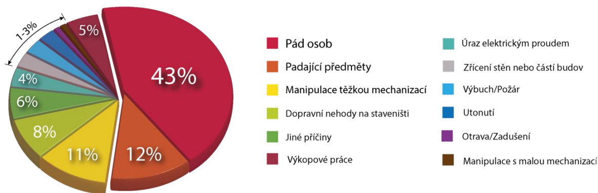
Obrázek 16: Příčiny smrtelných pracovních úrazů v EU za posledních 30 let [archiv spol. Skanska a.s.]
