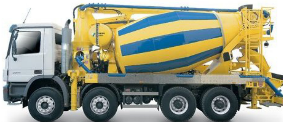
Obr. 9.7: Pohled na čerpadlo s autodomíchávačem
