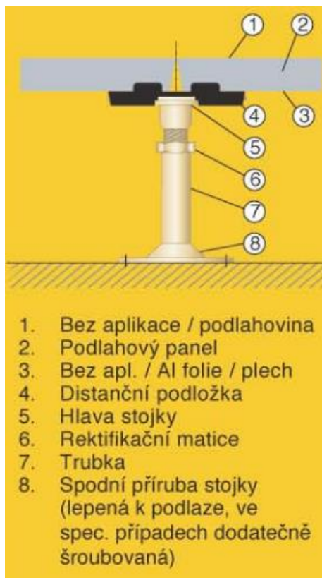
Obrázek 1: Detail zdvojené podlahy, převzato ze zdroje [29]
