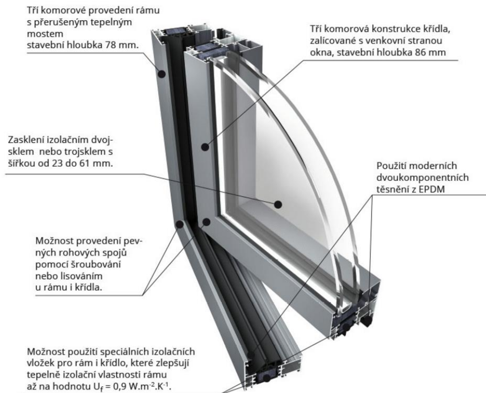
Obrázek 1: Technické parametry okenní výplně, převzato ze zdroje [23]
