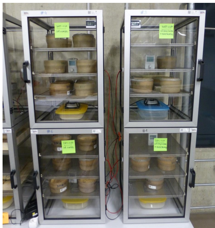
Obrázok 18 Vzorky v exsikátoroch počas 2 mesiacov, wet-cup hore, dry-cup dole
