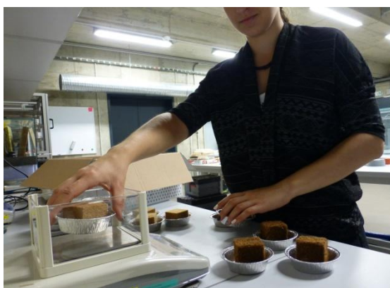
Obrázok 13 Priebežné váženie počas sorpcie
