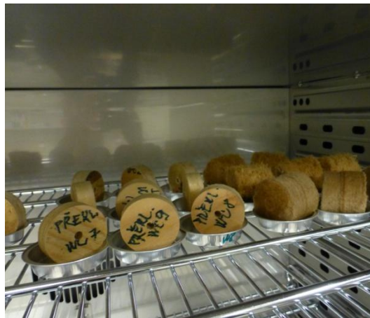
Obrázok 20 Sušenie výrezov na zistenie hmotnostnej vlhkosti
