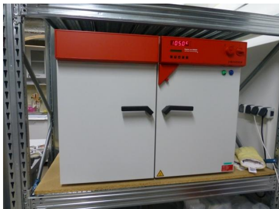
Obrázok 9 Sušiareň, sušenie na 105°C
