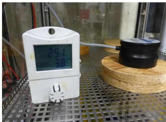
Obrázok 24 Meranie tepelnej vodivosti plošnou sondou
