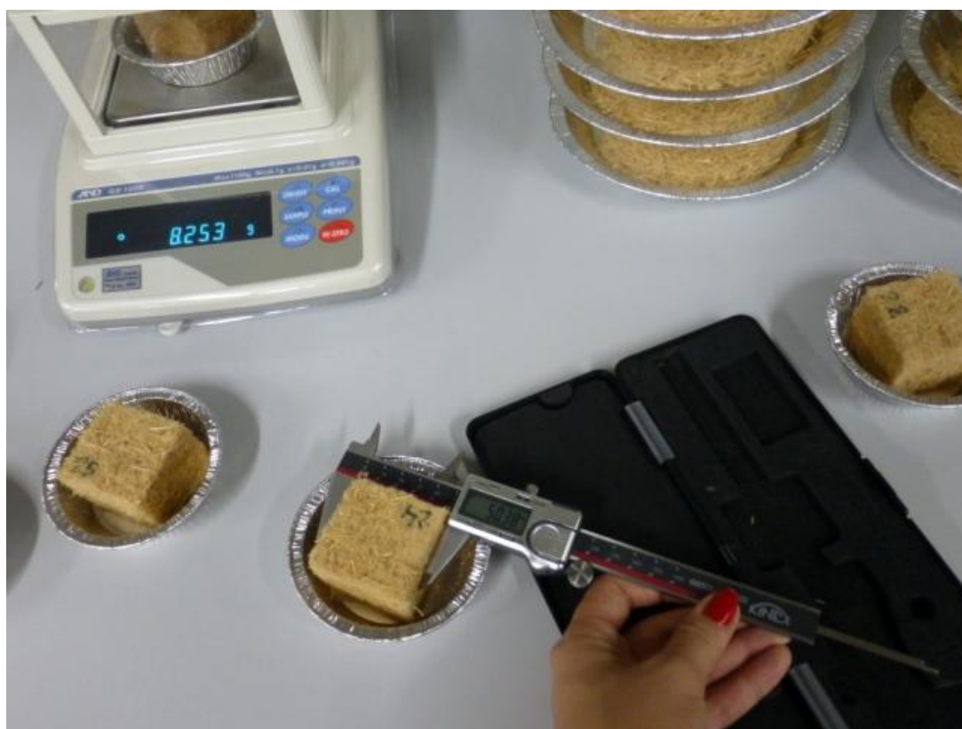
Obrázok 10 Váženie vzoriek digitálnymi váhami a meranie rozmerov vzoriek posuvným meradlom
