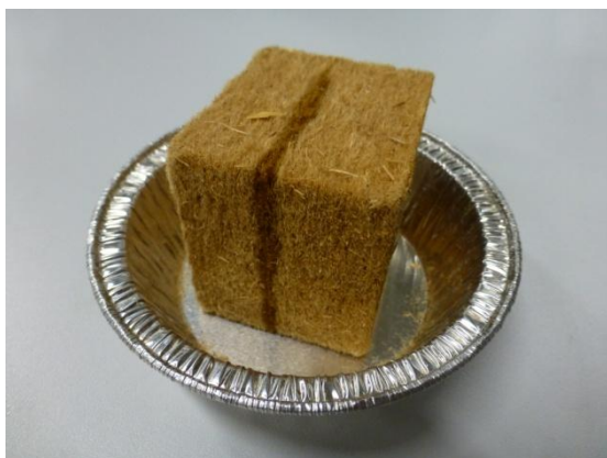
Obrázok 43 Miera rozpítia lepidla na STEICO-therm ustálenom na bod 5
