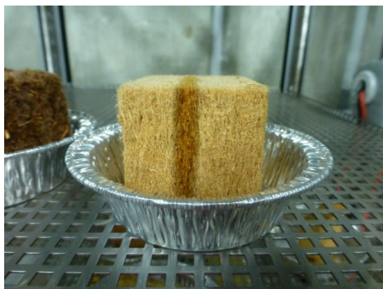
Obrázok 42 Miera rozpítia lepidla na STEICO-therm ustálenom na bod 6
