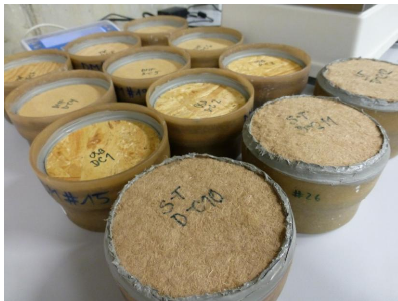
Obrázok 17 Vzorky pripravené na difúziu skúšku, konkrétne dry-cup
