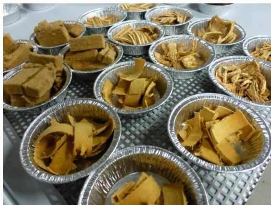
Obrázok 12 Vzorky roztriešené na menšie kúsky pre rýchlejšiu sorpciu
