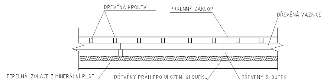
Obrázek 1.5-4: Schéma podélného řezu- Varianta s dřevěným horním pláštěm
