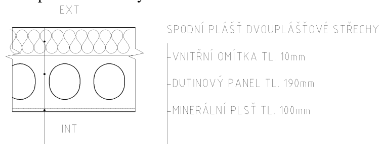
Obrázek 3.2-1: Skladba spodního pláště dvouplášťové ploché střechy
