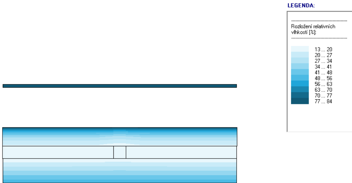
Obrázek 3.6-3: Rozložení relativních vlhkostí u dřevěného prahu
