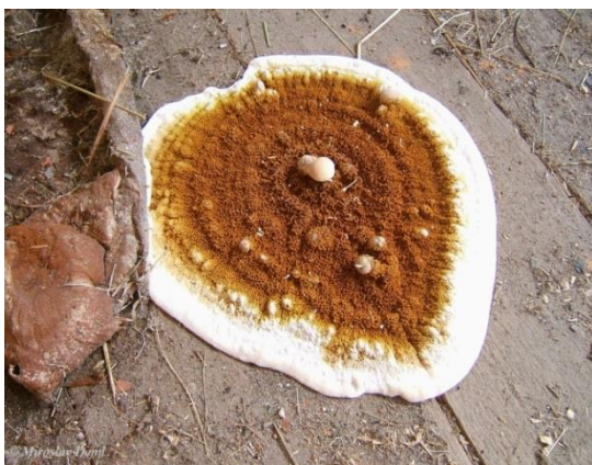
Obrázek 8: Plodnice dřevomorky domácí (4).
