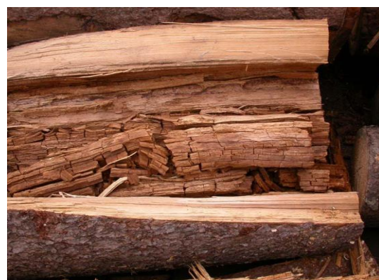
Obrázek 13: Kostkovitý rozklad uvnitř neopracovaného dřeva (9).
