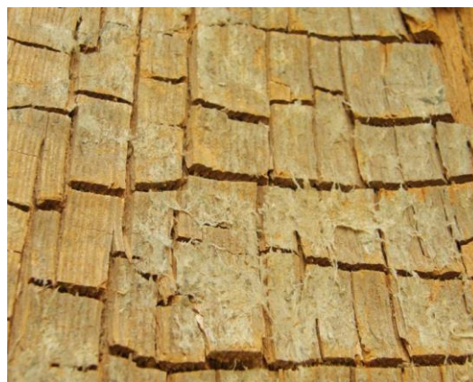
Obrázek 9: Rozpad dřeva na kostky větších formátů způsobený hnědou hnilobou (5).
