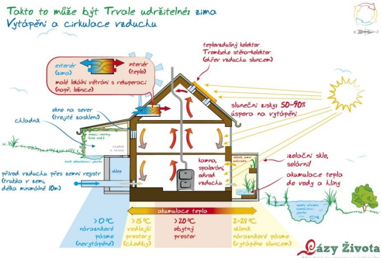
Obrázek 14 - Schéma vytápění a cirkulace vzduchu v zimě (5)
