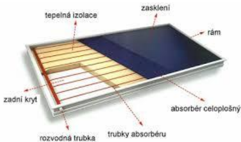
Obr. 5: Schéma plochého kolektoru, zdroj: Matuška T. - Solární soustavy pro bytové domy
