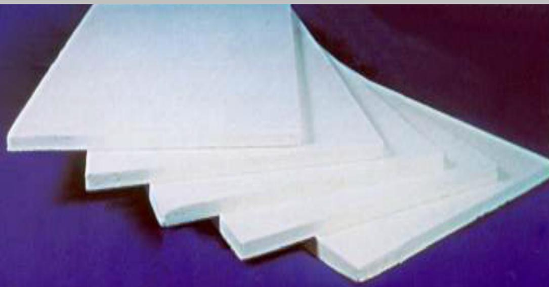
Desky FIBRATEC jsou vyrobeny z keramických vláken FIBRATEC, organických a anorganických pojiv. Jsou lehkým a žáruvzdorným izolačním materiálem do 1 650 °C. Desky FIBRATEC jsou vakuově tvarované výrobky, které odolávají vyšším rychlostem spalin v pecích než je tomu u rohoží.
