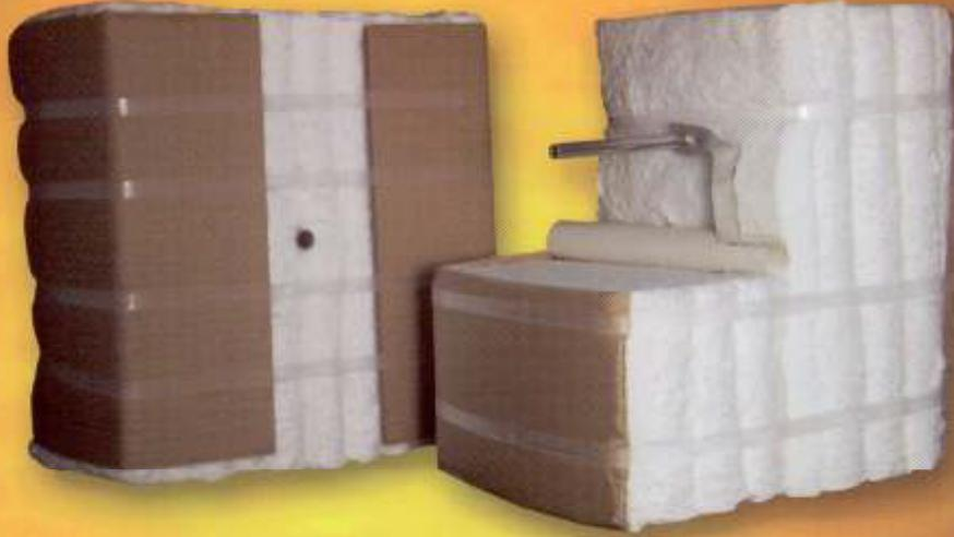
Moduly FIBRATEC jsou složeny a slisovány z přířezů rohoží FIBRATEC. Tyto moduly mají ze všech výrobků nejlepší isolační vlastnosti, neboť slisováním se dosahuje objemových hmotností až 240 kg·m<sup>-3</sup>.
