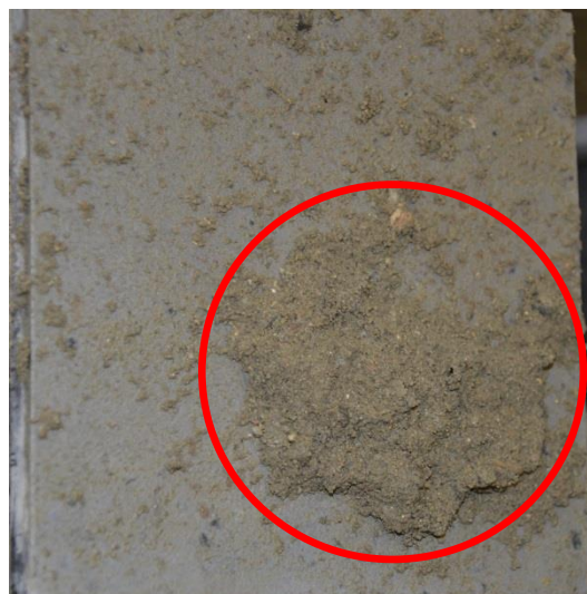
Obrázek 4-5 Přichycení části betonu na nástavci
