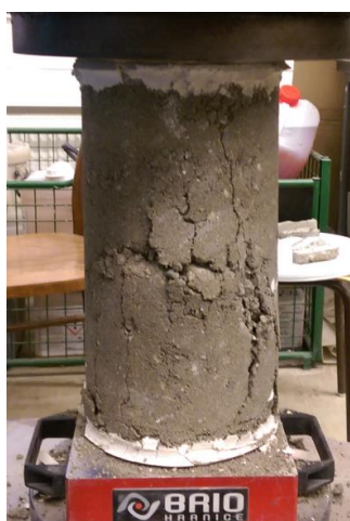
Obrázek 7-9 Porušení válcového tělesa při tlakové zkoušce
