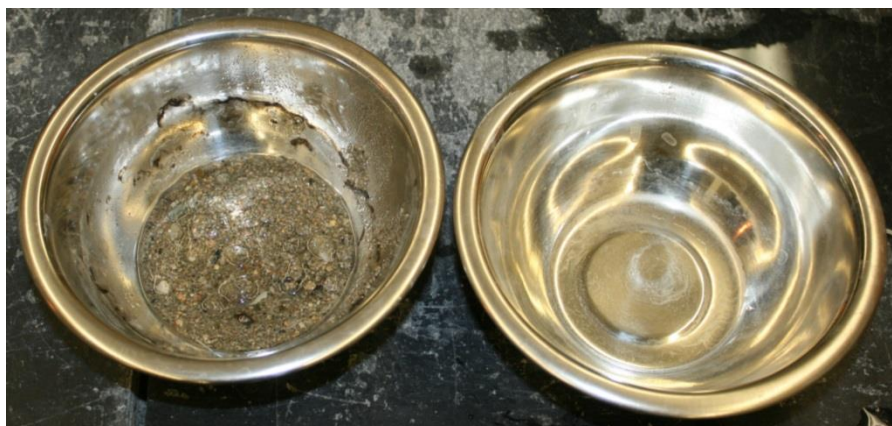
Obrázek 7-12 Odpad ze zkušební vzorku po ukončení 25. cyklu
