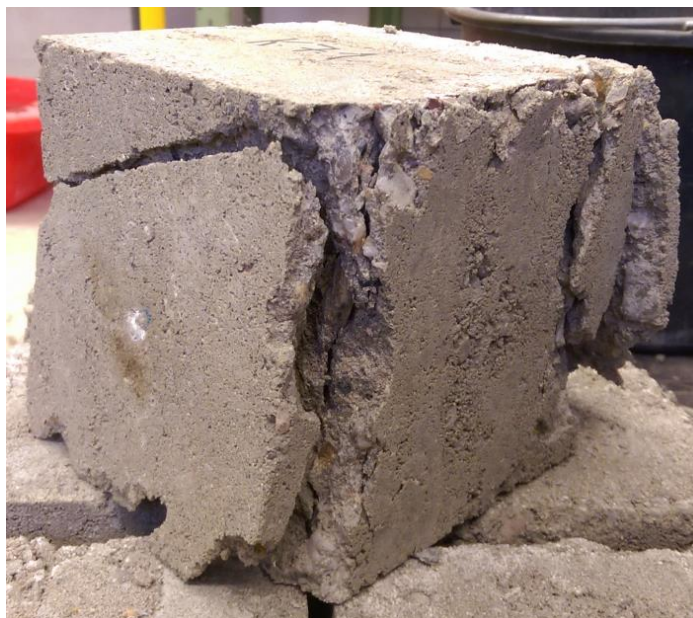
Obrázek 7-5 Porušení zkušebního tělesa při zkoušce pevnosti v tlaku
