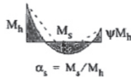
Obr. 17 – Průběh ohybového momentu M_y na sloupu E8
