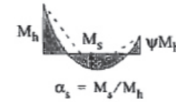
Obr. 20 – Průběh ohybového momentu M_y na sloupu E9
