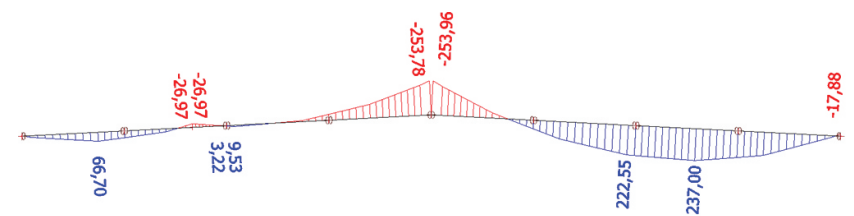
Obr. 16 – Průběh ohybového momentu M_y na vazníku 8
