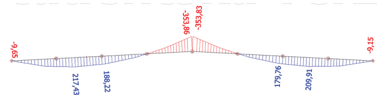
Obr. 22 – Průběh ohybového momentu M_y na vazníku 11
