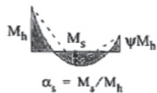
Obr. 1 – Průběh ohybového momentu M_y na vazníku 1
