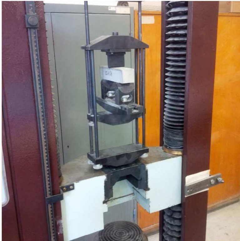
Obrázek 30: Zkouška tříbodovým ohybem
