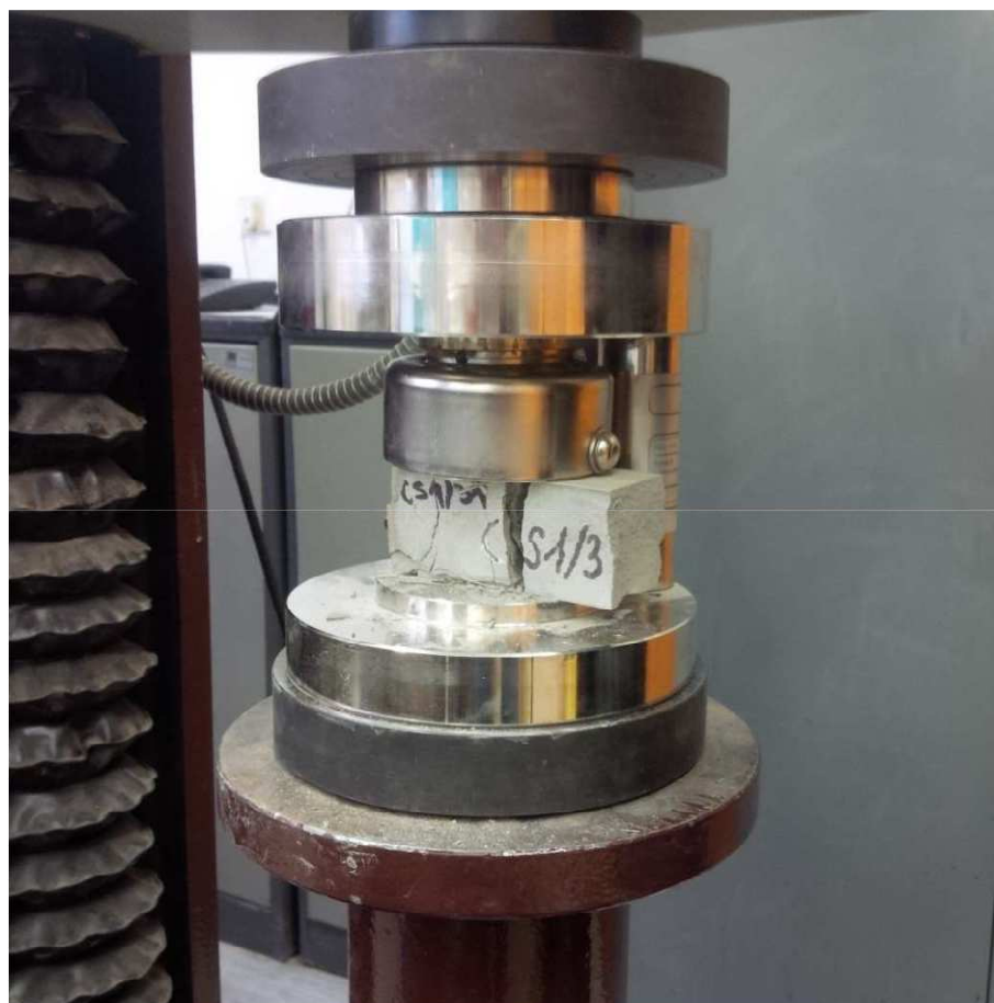
Obrázek 35: Zkouška jednoosým tlakem – destrukce vzorku
