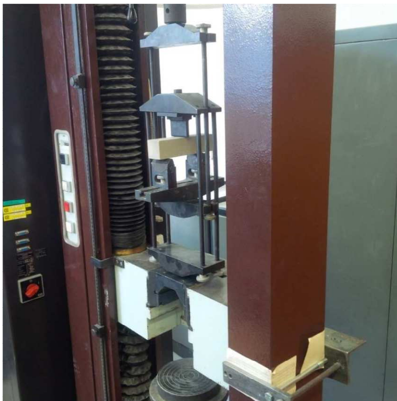
Obrázek 29: Zkouška tříbodovým ohybem
