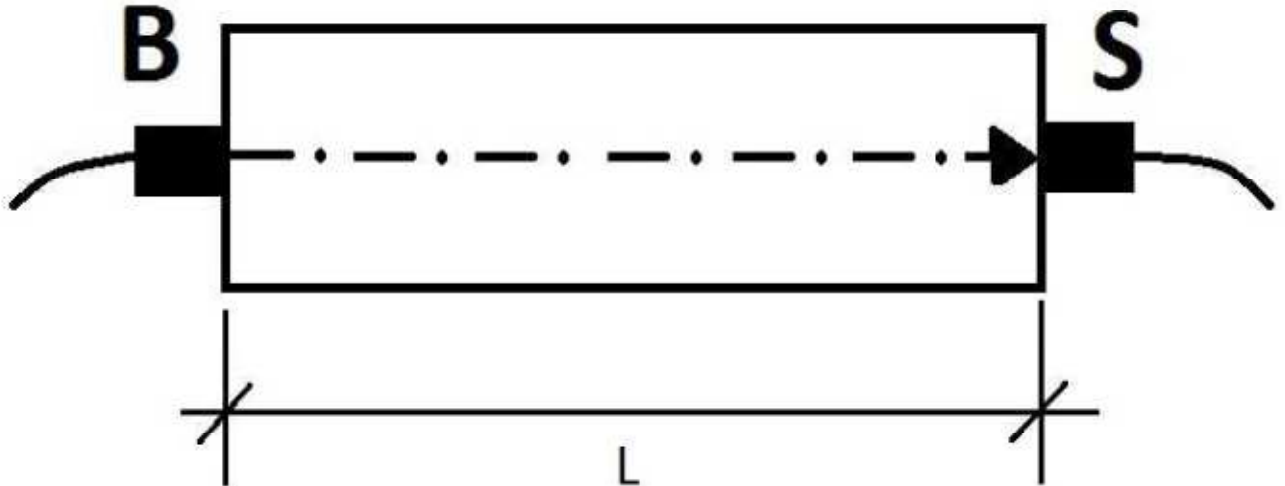
Obrázek 25: Schéma měření impulsovou ultrazvukovou metodou
