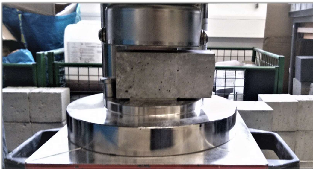
Obrázek 3-14 Fotografie - Vzorek připravený na zkoušku tlakové pevnosti
