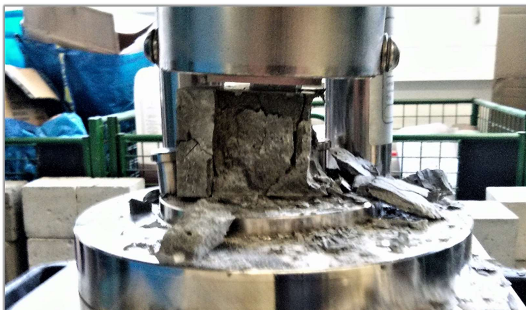
Obrázek 3-13 Fotografie - Vzorek po ukončení zkoušky tlakové pevnosti
