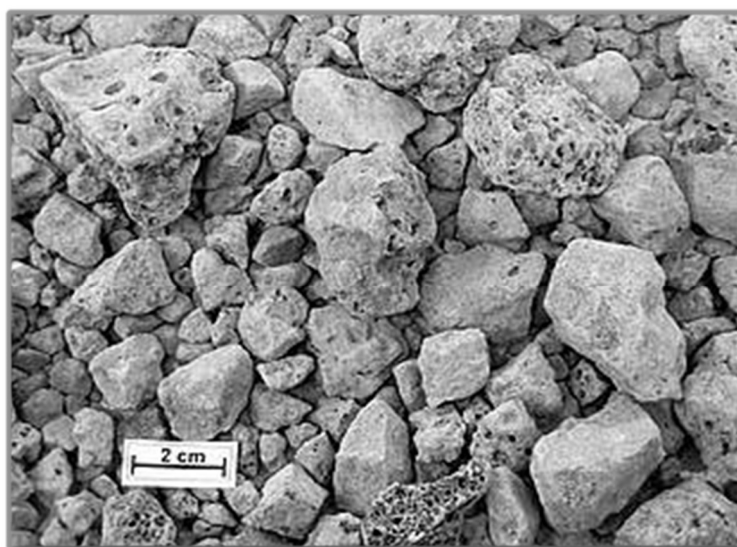
Obrázek 1-3 Vysokopecní struska chlazená vzduchem (Air-cooled blast furnace slag) [www.euroslag.org]
