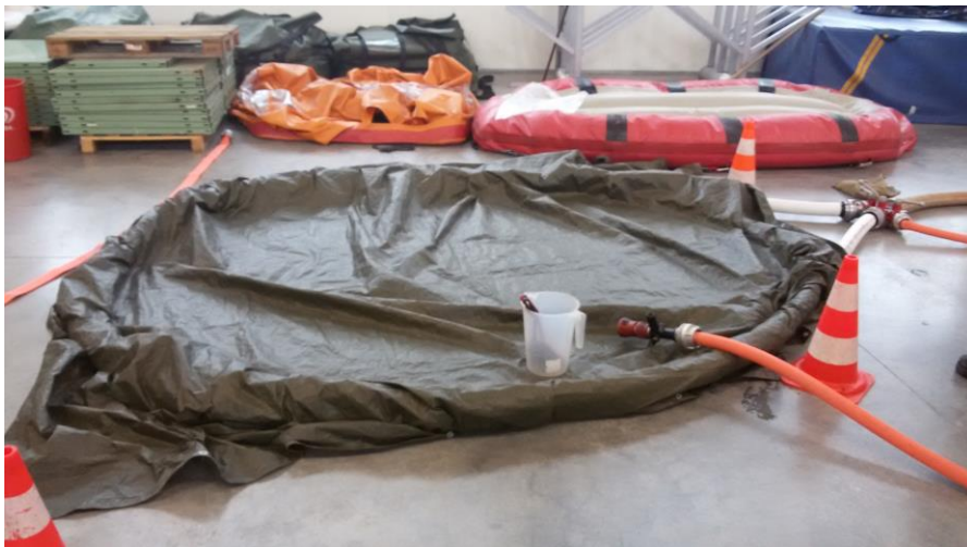
Foto 49 - Stavba zjednodušené dekonty (převlečení plachty)
