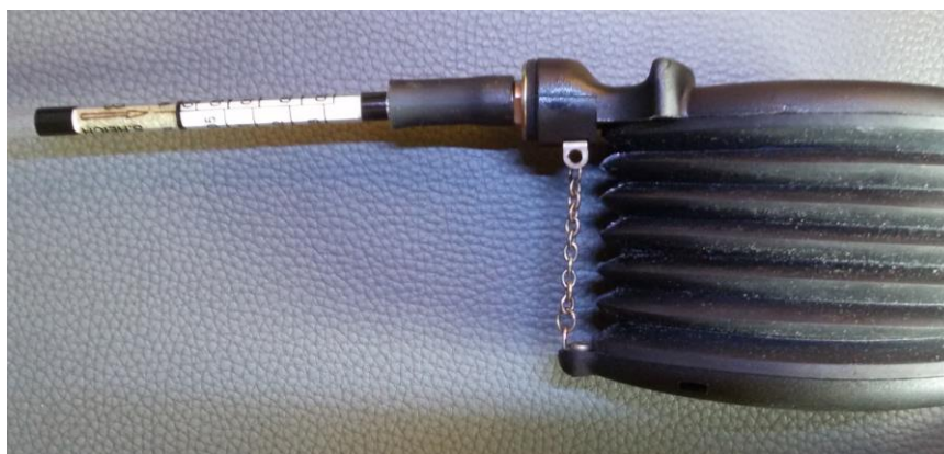
Foto 35 – Otevřená trubička vložena podle směru nasátí
