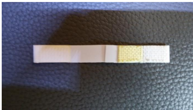
Foto 38 – Detehit – papírek s detekční, reakční a porovnávací tkaninou
