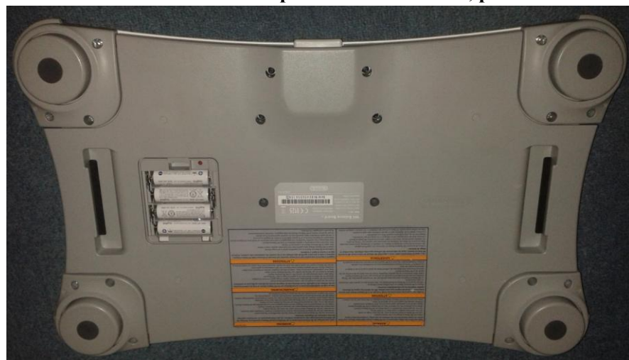
Obr. 13. - Stabilometrická plošina Nintendo Wii, pohled zespoda
