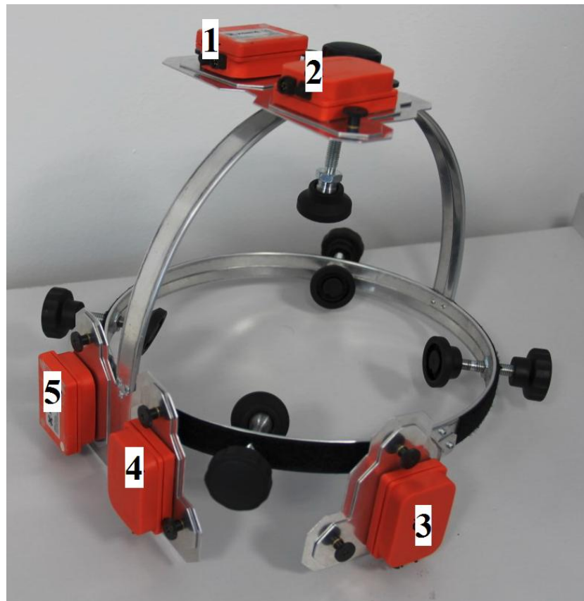
Obr. 10. – Gyro-akcelerometrická helma s rozmiřtými senzory Xsens
