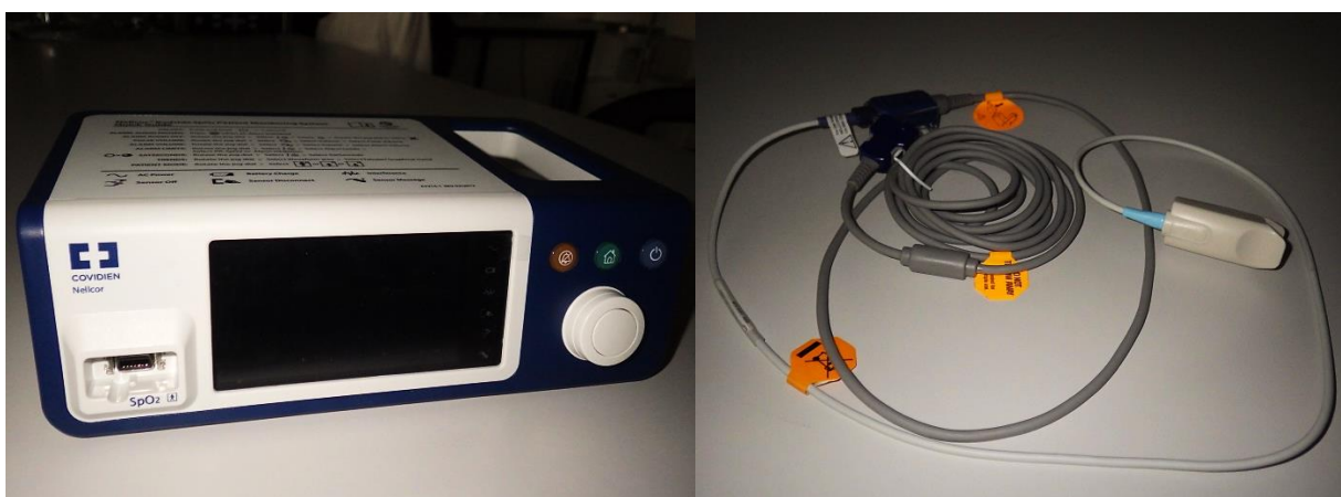
Obrázek č. 2.9: Pulzní oxymetr Nellcor N-600 (nalevo) a senzor pulzní oxymetrie (napravo).
