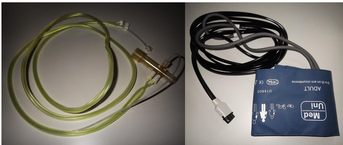
Obrázek č. 2.11: Měřicí clonka (nalevo) a tlaková manžeta (napravo).
