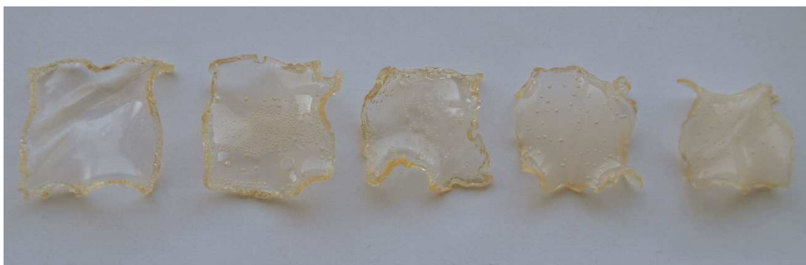
P/10 Matrice z poly(HEMA-co-EDMA) s obsahem porogenu 10 a 20 % po zbotnění
