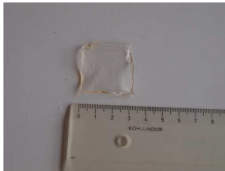
P/8 Matrice z poly(HEMA-co-EDMA) s 15% obsahem benzokainu před a po zbotnění
