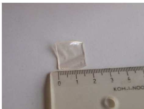
P/8 Matrice z poly(HEMA-co-EDMA) s 15% obsahem benzokainu před a po zbotnění
