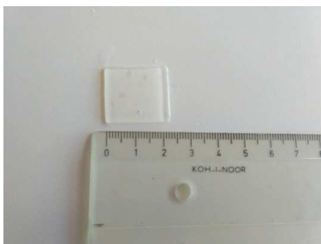
P/14 Matrice z poly(HEMA-co-MA) s 40% obsahem benzokainu před a po zbotnění
