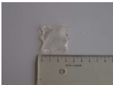
P/10 Matrice z poly(HEMA-co-EDMA) s obsahem porogenu 10 a 20 % po zbotnění
