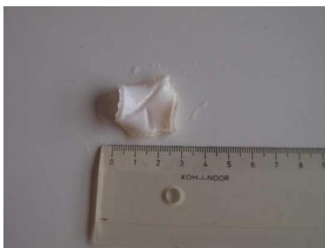
P/13 Matrice z poly(HEMA-co-MA) s 15% obsahem benzokainu před a po zbotnění
