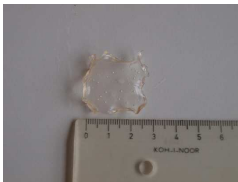
P/11 Matrice z poly(HEMA-co-EDMA) s obsahem porogenu 30 a 40 % po zbotnění
