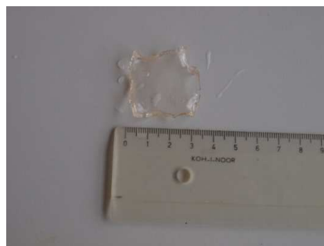
P/10 Matrice z poly(HEMA-co-EDMA) s obsahem porogenu 10 a 20 % po zbotnění
