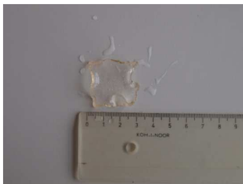
P/11 Matrice z poly(HEMA-co-EDMA) s obsahem porogenu 30 a 40 % po zbotnění
