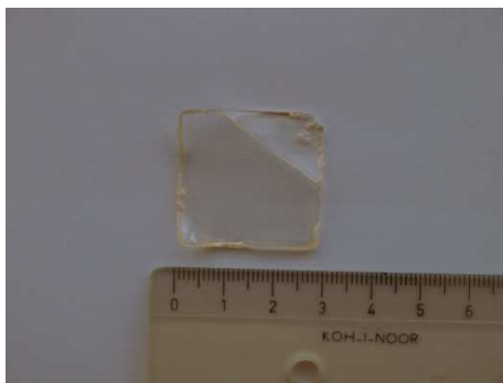
P/8 Matrice z poly(HEMA-co-EDMA) s 15% obsahem benzokainu před a po zbotnění
