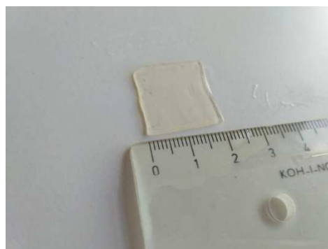
P/8 Matrice z poly(HEMA-co-EDMA) s 15% obsahem benzokainu před a po zbotnění
