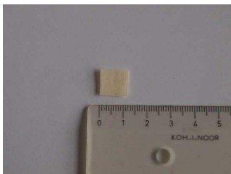
P/14 Matrice z poly(HEMA-co-MA) s 40% obsahem benzokainu před a po zbotnění
