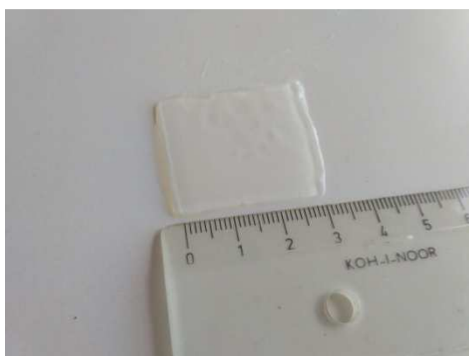
P/13 Matrice z poly(HEMA-co-MA) s 15% obsahem benzokainu před a po zbotnění
