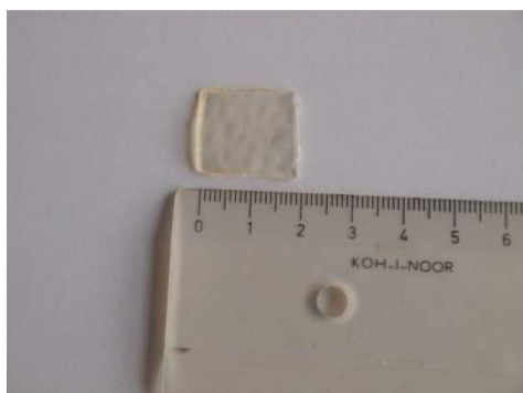
P/13 Matrice z poly(HEMA-co-MA) s 15% obsahem benzokainu před a po zbotnění
