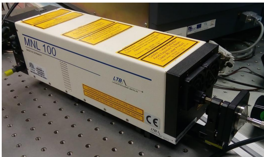
Obrázek 21 - UV dusíkový laser MNL 100 firmy Laser Technik Berlin použitý jako zdroj pro přímou excitaci luminiscenčních center
