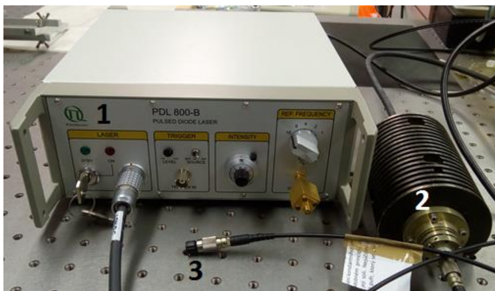
Obrázek 23 – Modrý pikosekundový laser PicoQuant, 1 – driver k laseru, 2 – odnímatelná hlava samotného modrého laseru, 3 – výstup laserového paprsku optickým vláknem
