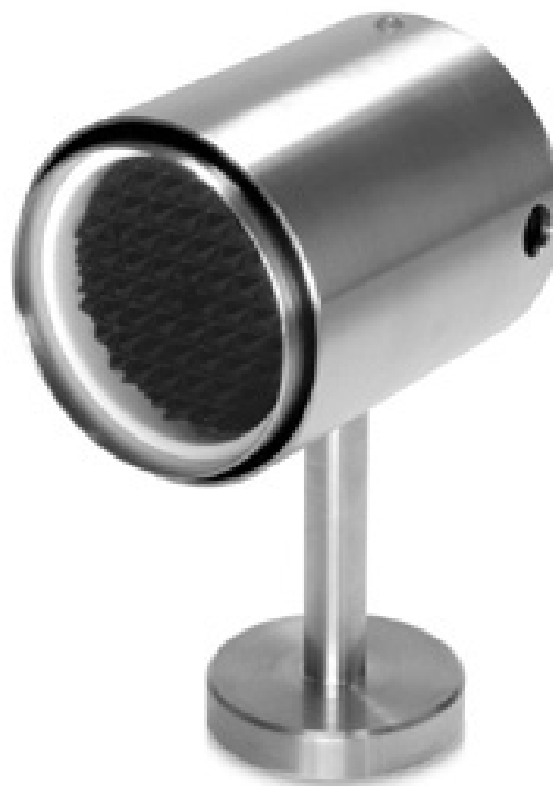
Obr. 2.4: používané černé těleso Kleiber KBB 35. Převzato z [25].
