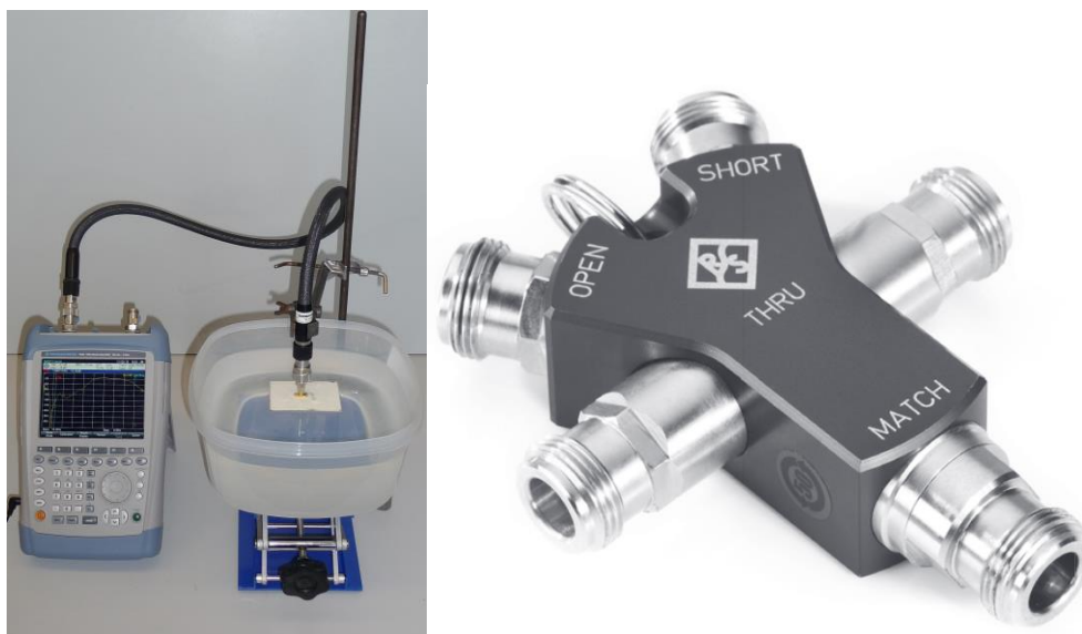
Obr. 3.22 Prostředí měření charakteristik motýlkových antén pomocí VNA vlevo a kalibrační standard vpravo
