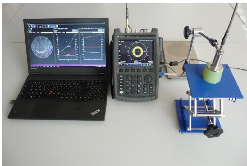
Obr. 3.23 Prostředí měření dielektrických parametrů pomocí DAK Schmid & Partner Engineering AG, vpravo sonda otevřeného konce koaxiálního vedení, uprostřed VNA od firmy Keysight a vlevo počítač se softwarem pro zobrazení měřených dat
