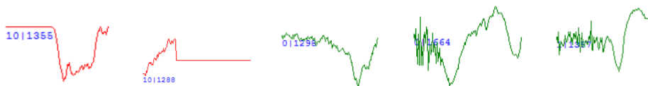
Obrázek 29: Příklady špatně nasegmentovaných segmentů, které jsou odstraněny ze statistického zpracování. Segmenty jsou vzaty z reálného záznamu EEG zobrazeného programem WF [5].
