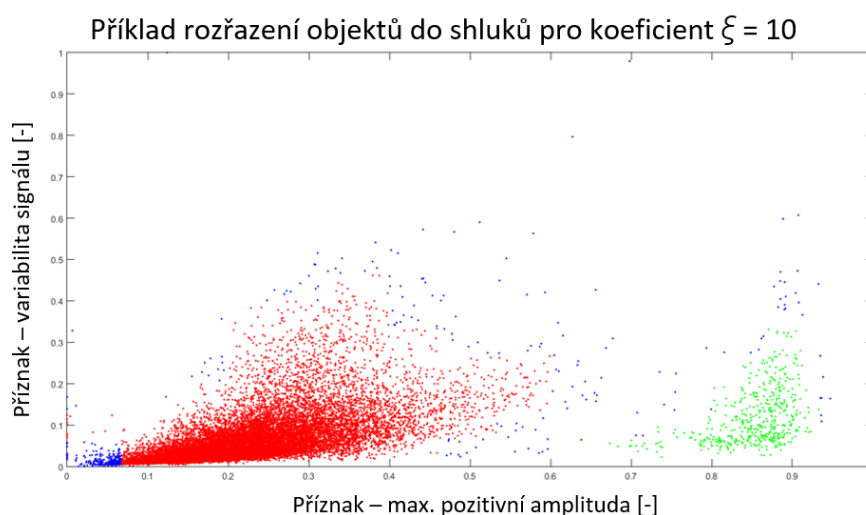
Obrázek 37: Příklad rozdělení objektů do shluků u algoritmu DENCLUE a příznaků „variabilita signálu v daném segmentu“ a „maximální pozitivní amplituda v daném segmentu“. Příklad je vytvořen pro počet buněk histogramu k = 20 a koeficient šumu \xi = 10 .
