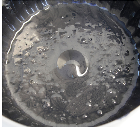
Obrázek 21: Smíchání grafitového prášku se silikonem
