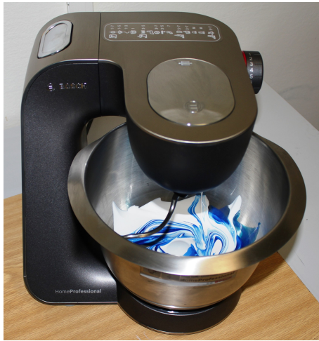
Obrázek 20: Smíchání silikonu a katalyzátoru
