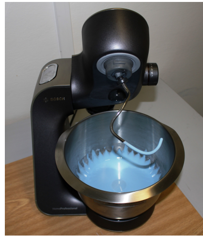
Obrázek 20: Smíchání silikonu a katalyzátoru
