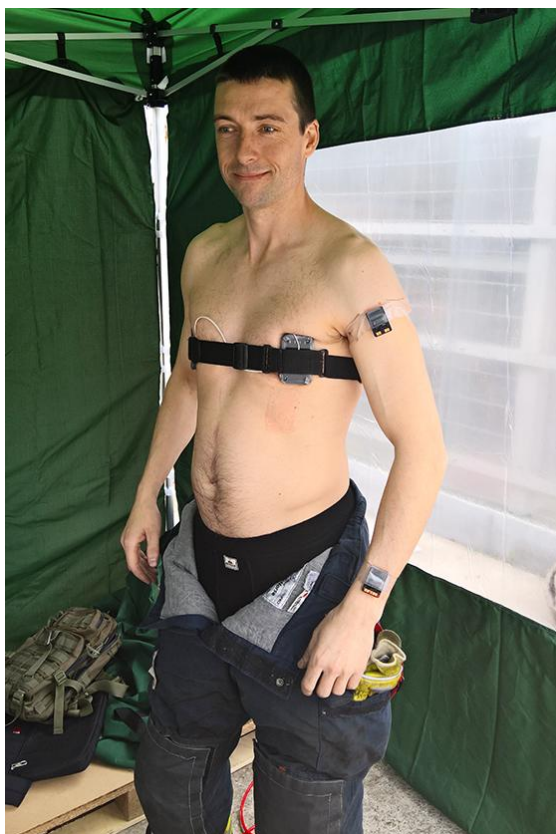
Obr. 45: Člen HZS vybavený senzorickými jednotkami detekce ionizujícího záření, teploty a vlhkosti a vysílací jednotky pro bezdrátovou komunikaci s centrální jednotkou.
