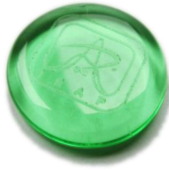
Obr. 16: Zdroj slabého ionizujícího záření použitý pro ozařování testovacích sensorových modulů - sklo obarvené uranovým barvivem.
