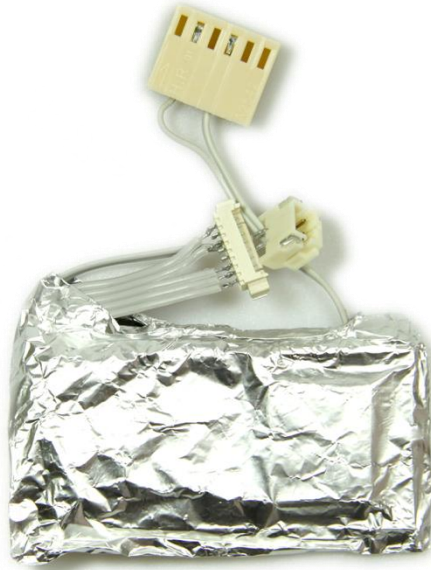
Obr. 37: Zkompletovaný senzorový modul odstíněný hliníkovou folií.
