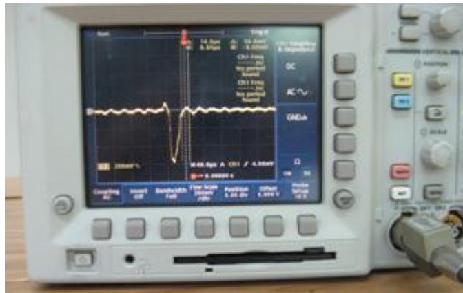
Obr. 5: Záznam napětového pulzu získaného sensorovým modulem při detekci částice [13].
