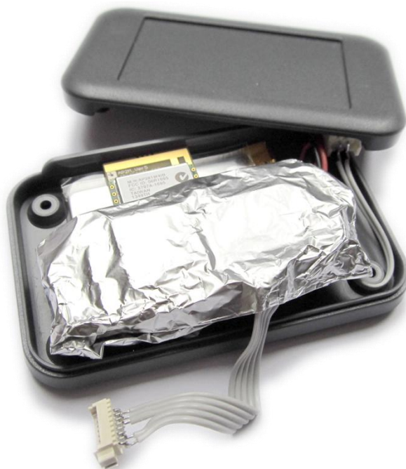
Obr. 44: Zkompletovaná senzorická jednotka s funkčním vzorkem sensorového modulu detekce ionizujícího záření, bezdrátovým modulem a napájecím akumulátorem.
