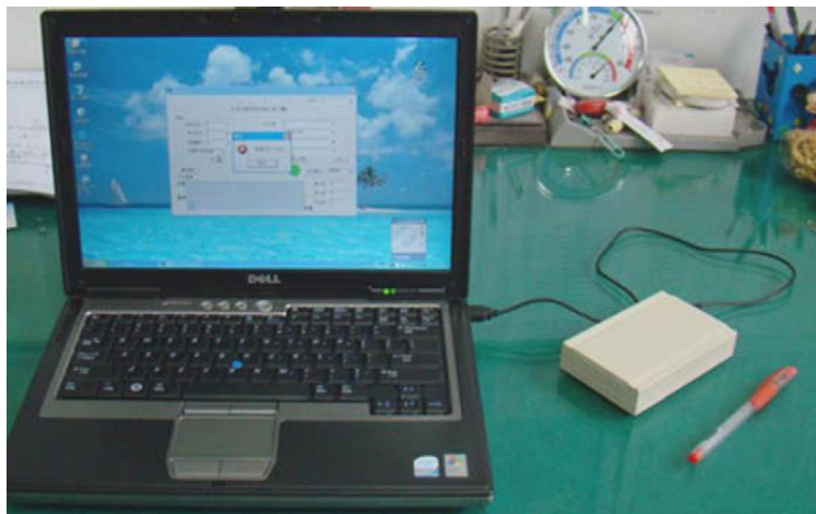
Obr. 2: Zapouzdřený funkční vzorek detektoru ionizujícího záření s Geiger-Müllerovým čítačem (vpravo) [1].
