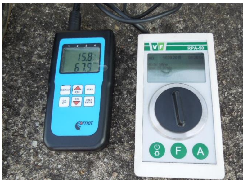
Obr. 8 - Comet Commeter a analyzátor produktů přeměny radonu RPA – 50 [vlastní]
