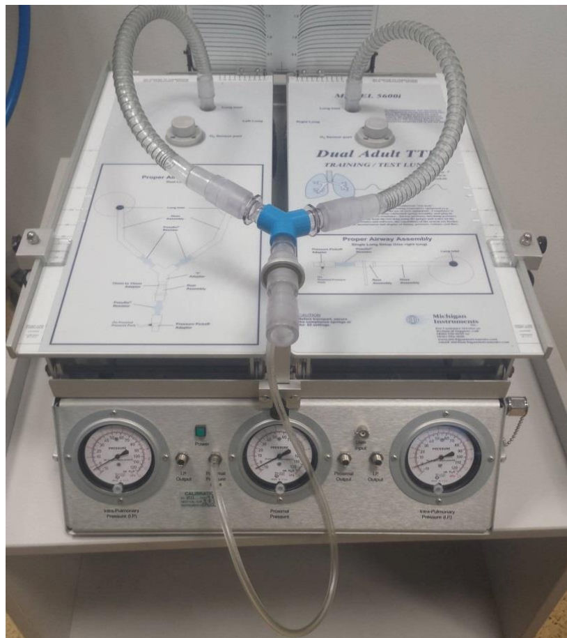
Obr. 8: Mechanické testovací plice 5600i. (fotodokumentace autora)
