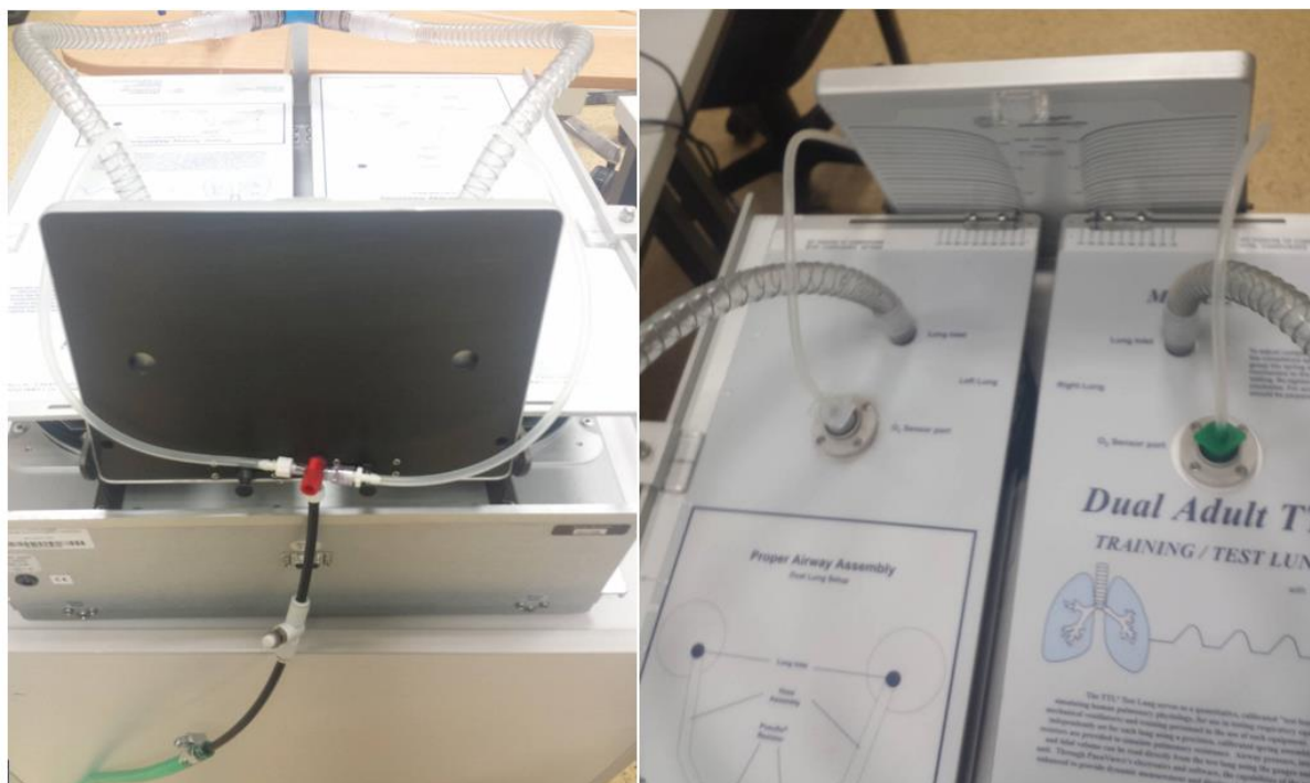
Obr. 16: Zapojení přípravku pro insuflaci CO 2 do mechanických plic. Připojení k vývodů CO 2 lahve lze vidět vlevo a napojení přípravku do O 2 portů vpravo.
