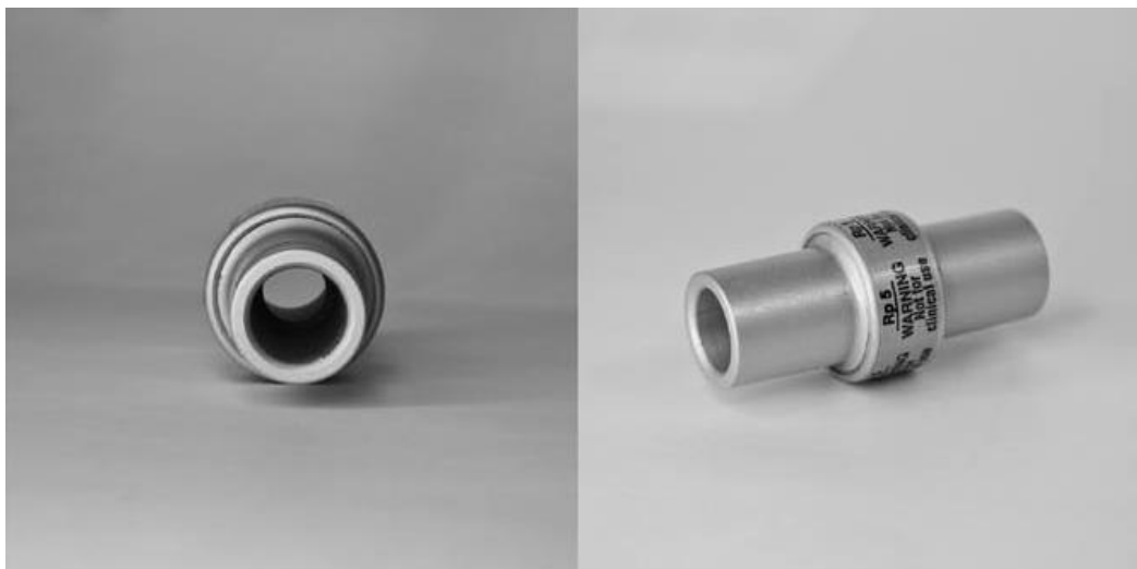
Obr. 19: Komerčně dostupný parabolický rezistor (Michigan Instruments, Grand Rapids, USA): pohled na clonu rezistoru Rp 5 (vlevo) a celkový pohled z vnějšku na Rp 5 (vpravo). Převzato [30]
