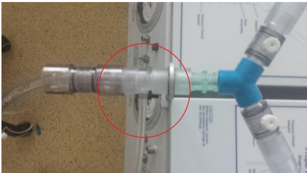
Obr. 13: Nástavec s vývodem, použitý jako insuflační bod pro ověřovaný okruh.
