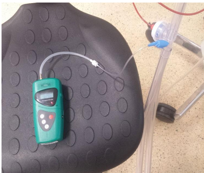
Příloha C: CO 2 analyzátor propojený s tenkou kanylou a zavedení do bodu 76 cm od Y-spojky.
