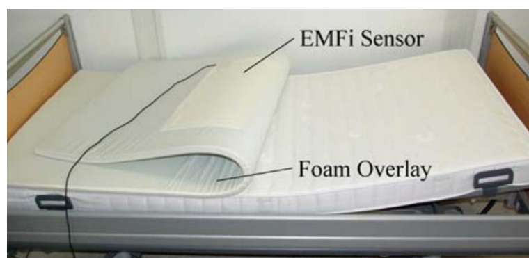
Obrázek 2.9: Na obrázku je vyfocené technické řešení umístění tenzometrické folie pod pěnovou matrací, která je s fólií spojena a přenáší fyziologické pohyby na senzor, které jsou dále odesílány na zpracování do výpočetní jednotky. [9]
