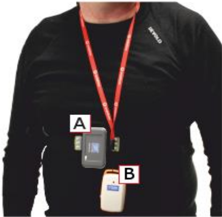
Obrázek 2.6: Hrudní pás pro měření dechové frekvence (vlevo). (a pravo) Jako součást systému FlexiGuard se zobrazena sběrnou jednotkou.
