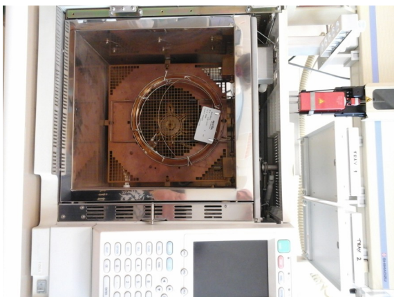
Obrázek 20,21– Plynový chromatograf Shimadzu GC-2010, vnitřek přístroje s kolonou
