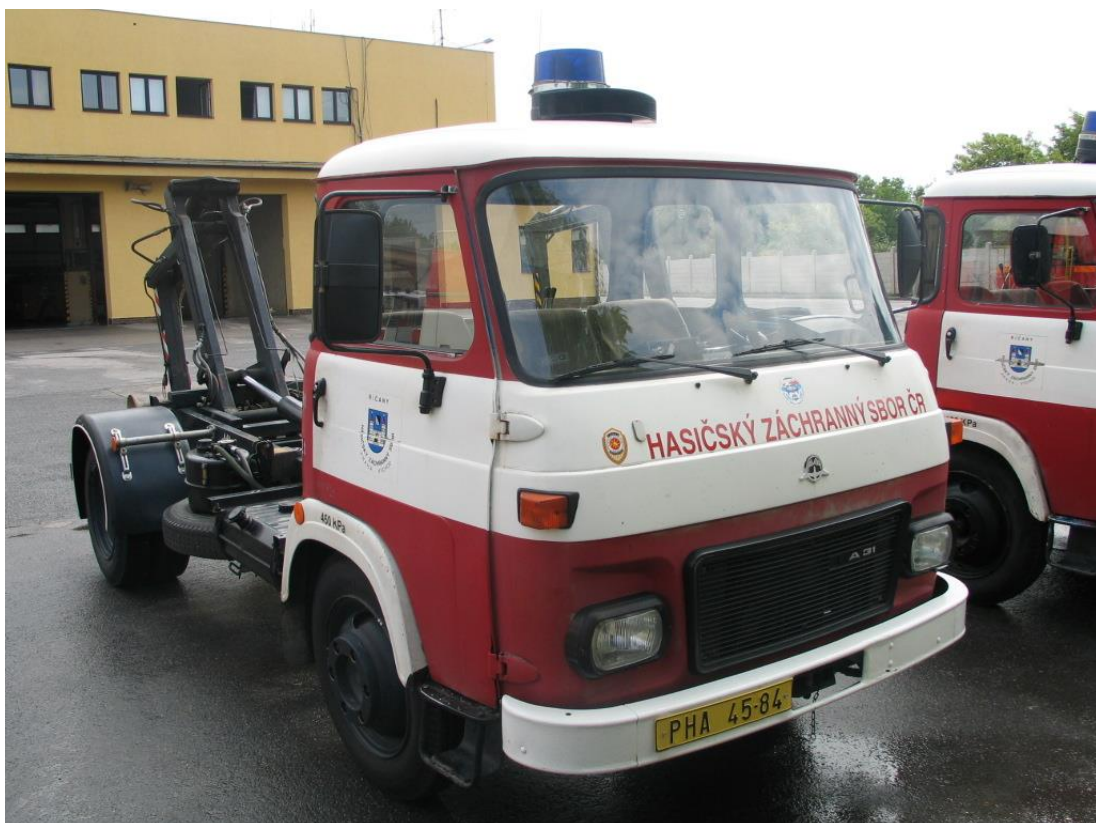
Obrázek 5: Kloubový natahovací mechanismus na vozidle Avia
