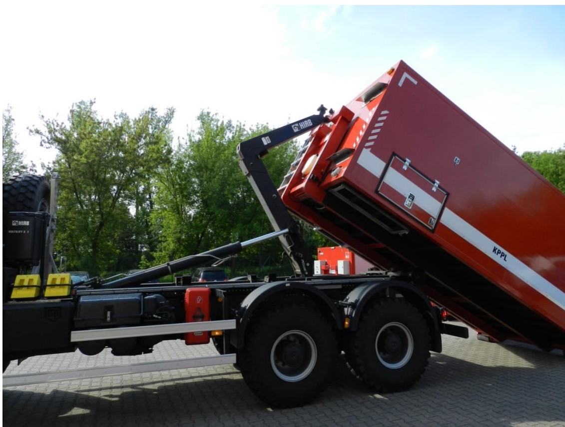
Obrázek 11: Natahovací mechanismus při skládání kontejneru Zdroj: Stanice HZS Kutná Hora/Jan Kosík
