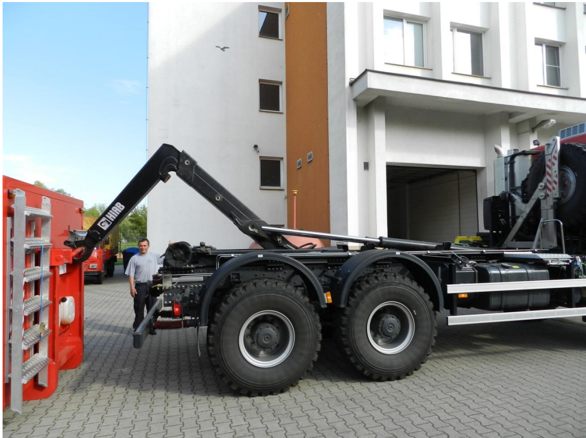
Obrázek 12: Natahovací mechanismus při skládání kontejneru Zdroj: Stanice HZS Kutná Hora/Jan Kosík
