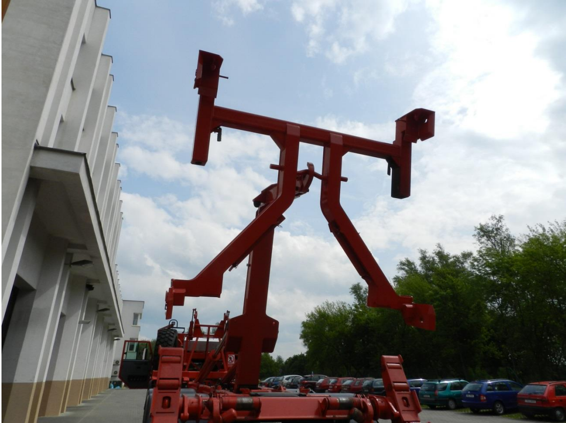
Obrázek 7: H rám na teleskopickém natahovacím mechanismu
