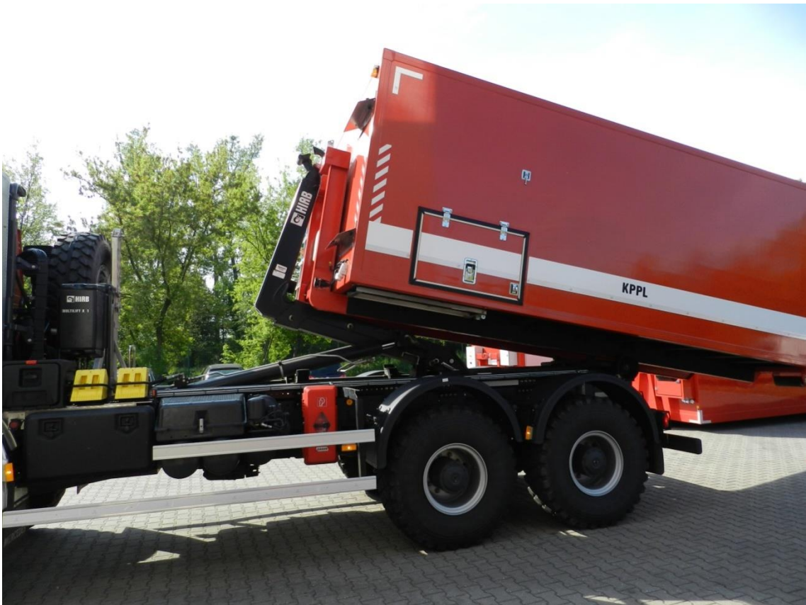
Obrázek 9: Natahovací mechanismus při skládání kontejneru
