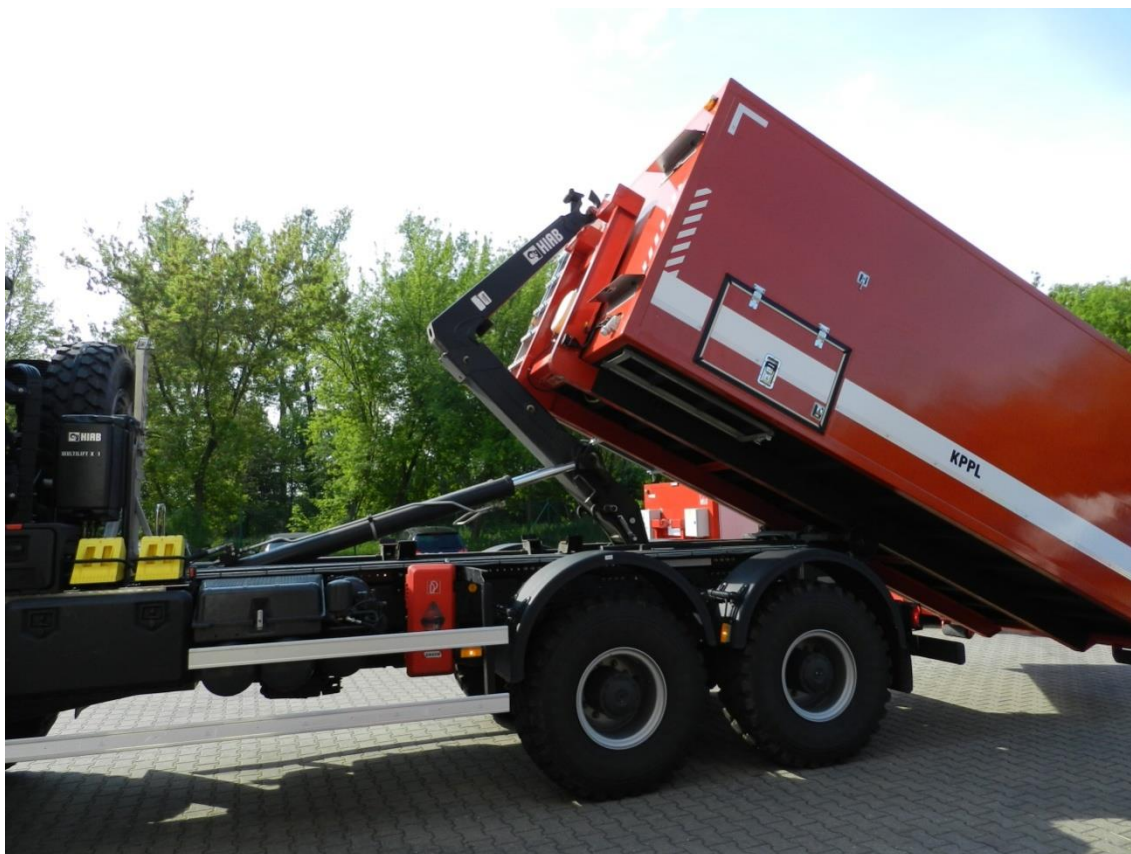
Obrázek 10: Natahovací mechanismus při skládání kontejneru Zdroj: Stanice HZS Kutná Hora/Jan Kosík
