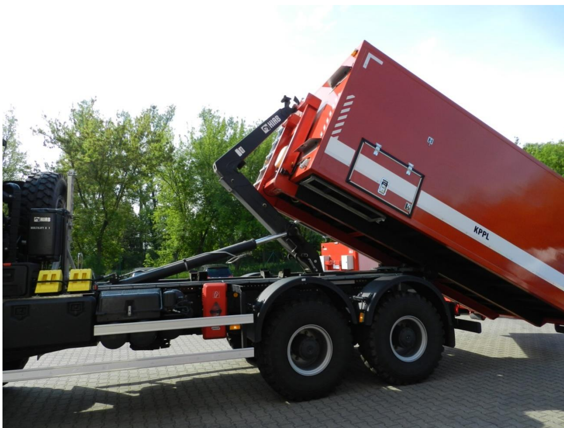
Obrázek 6: Teleskopický natahovací mechanismus
