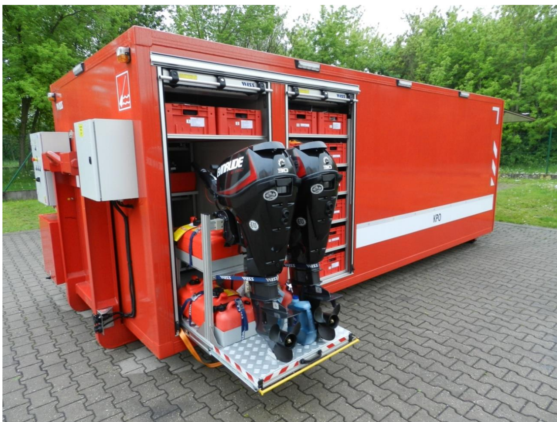
Obrázek 3: Protipovodňový kontejner – technologická část
