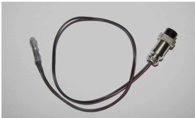
Obrázek 23: Senzor NTC opatřený izolací proti vlhkosti. Fotografie: autor.
