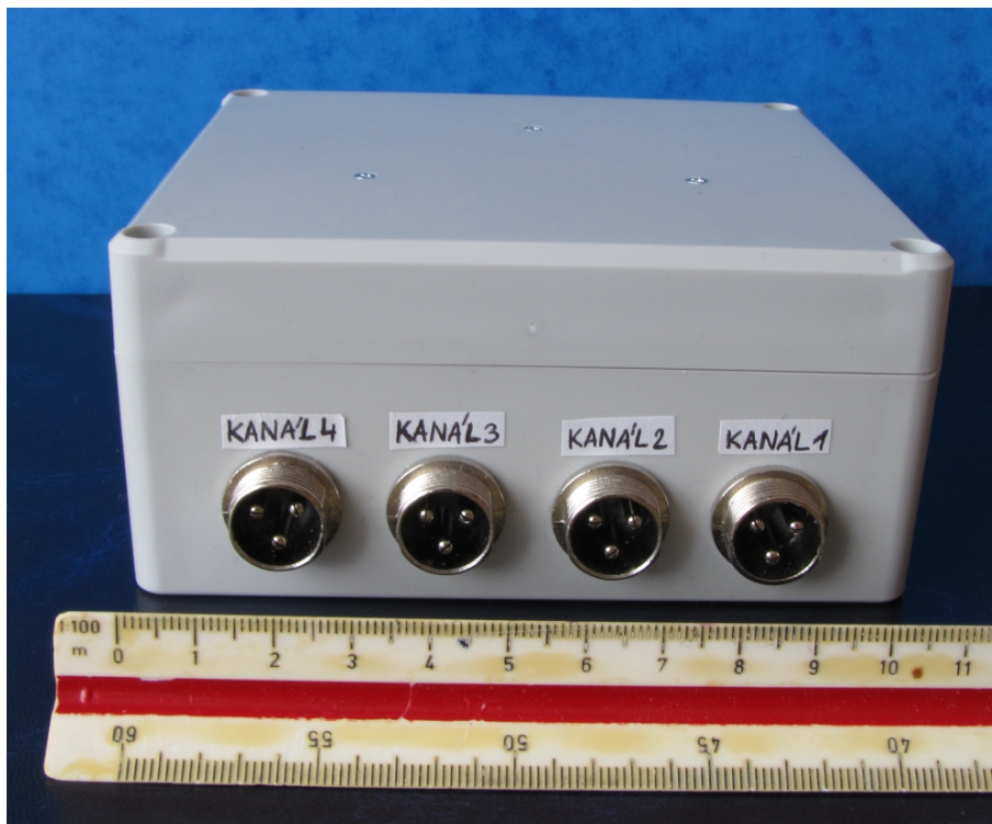
Obrázek 18: Zařízení z pohledu na konektory pro senzory. Fotografie: autor.
