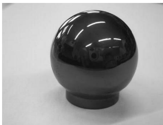
Obrázek 11 Hlavice kyčelního kloubu pokrytá DLC [23]
