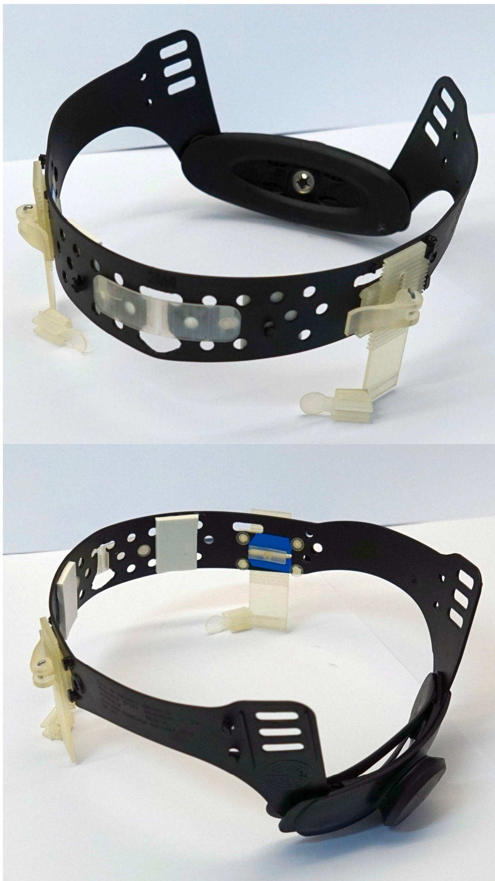
Obrázek 2.11 - Nové uchycení ve dvou pohledech
