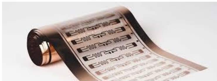
Obr. 11 Ukázka natištěných rezistorů, převzato z [17]
