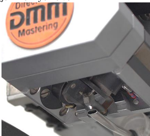
Obr. 2.5: Detail řezací hlavy (převzato z internetu 3 )
