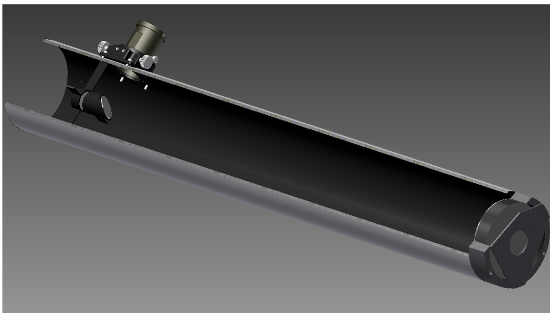
Obrázek 5.6: Návrh optické soustavy v dalekohledu Newton
