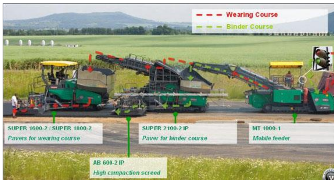
Obrázek 2: Schéma pokládky Inline Pave [4]
