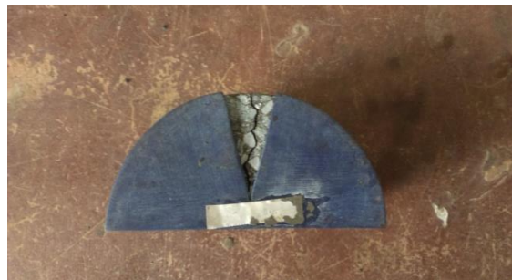
Obrázek 26: Kontrola trhliny pomocí příložné desky
