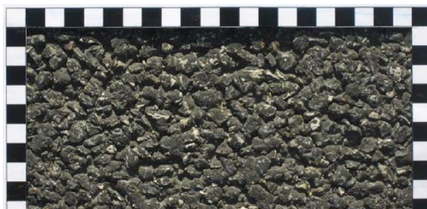
Obrázek 4: Povrch UTLAC 8- šachovnice je 10x10mm [8]
