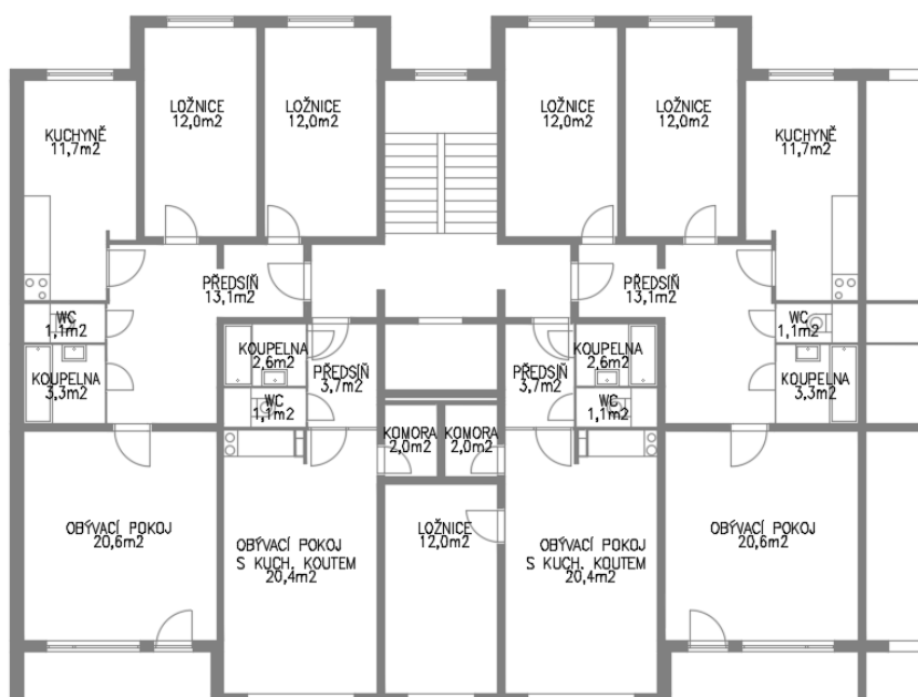
Obr. 9 Půdorys typického podlaží (krajní sekce)
