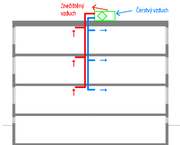
Obr. 8 Schéma centrálního rovnotlakého systému
