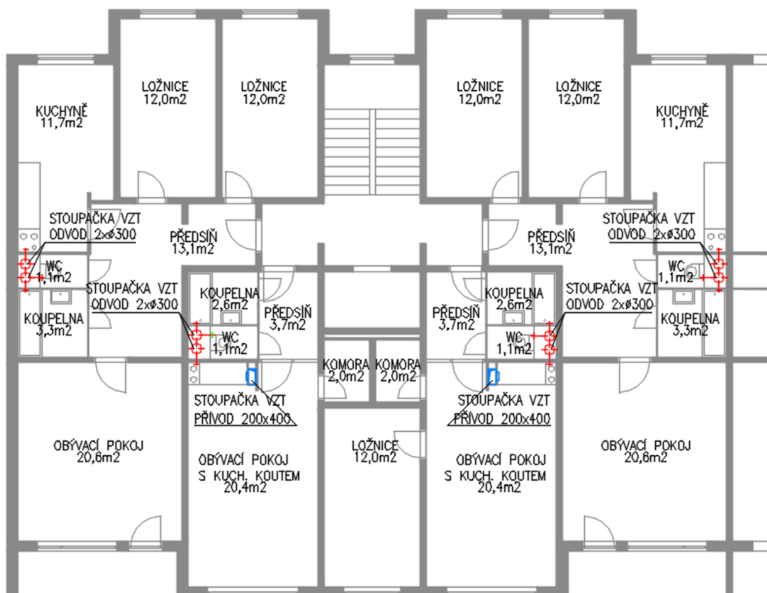
Obr. 11 Rozmístění stoupacích potrubí vzduchotechniky v půdorysu podlaží
