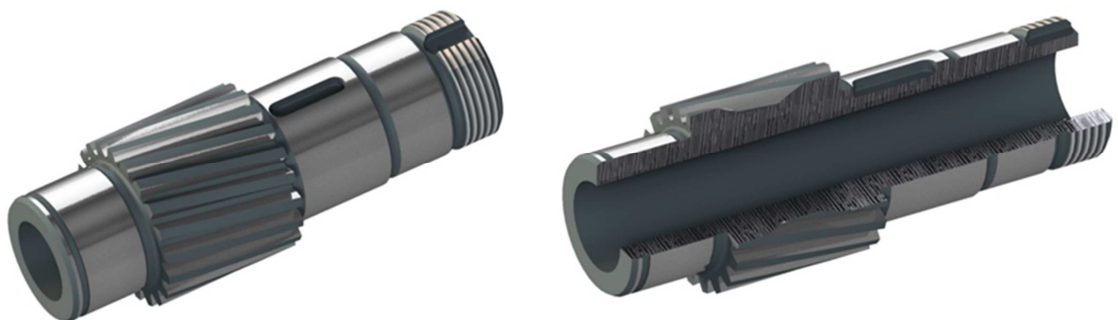
Obrázek 27: Model navrženého pastorku (vytvořeno v programu Autodesk Inventor 2017)
