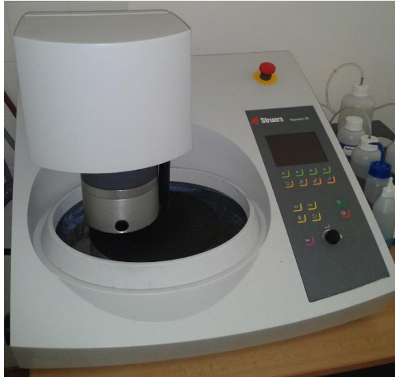
Obr. 5.8 Automatická metalografická bruska Tegramin 25
