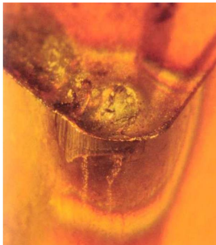
Obr. 3.10 Opotřebení nástroje žlábkem na čele břitu [10]
