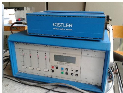
Obr. 5.3 Dynamometr a vyhodnocovací zařízení
