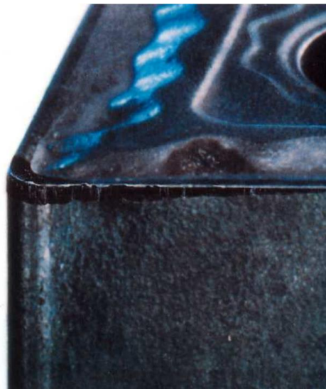
Obr. 3.9 Opotřebení hřbetu nástroje [10]
