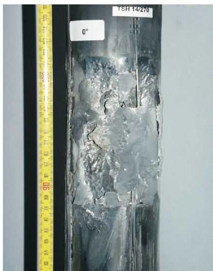
Obrázek 2.4: Stav pláště na horním konci vyhřívané oblasti po ukončení testu. [30]
