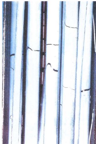
Obrázek 2.3: Porušení pokrytí palivových tyčí ve výškové úrovni 900 mm. [27]
