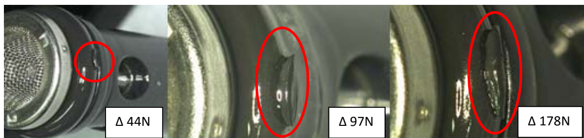
Obr. 5.3.3 Příklady stříženého o-kroužku při zalisování
